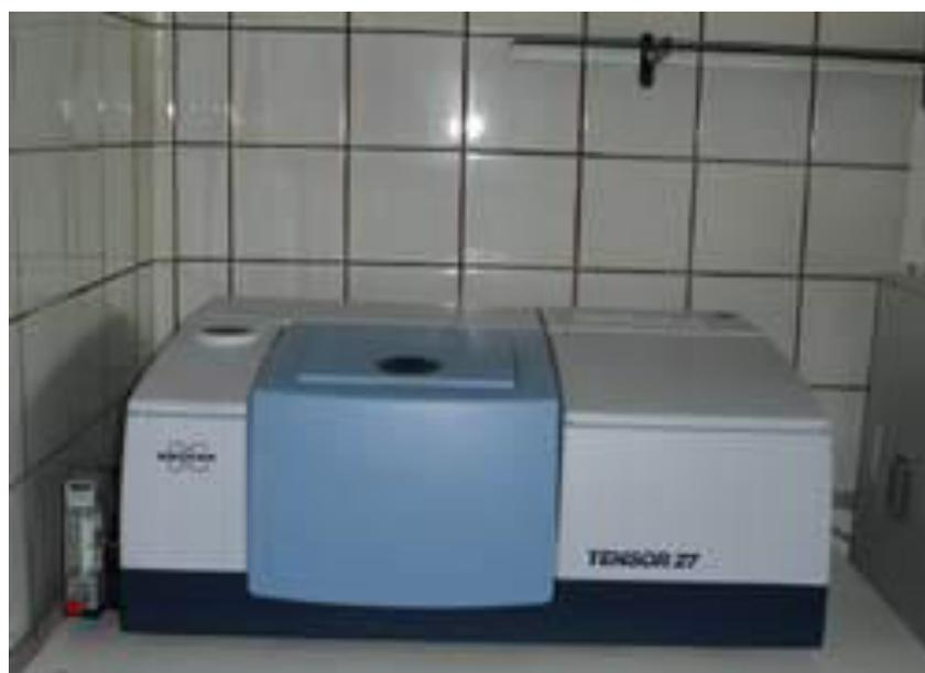
Figure II.8: L'appareil de spectroscopie Infrarouge de laboratoire LCPM
