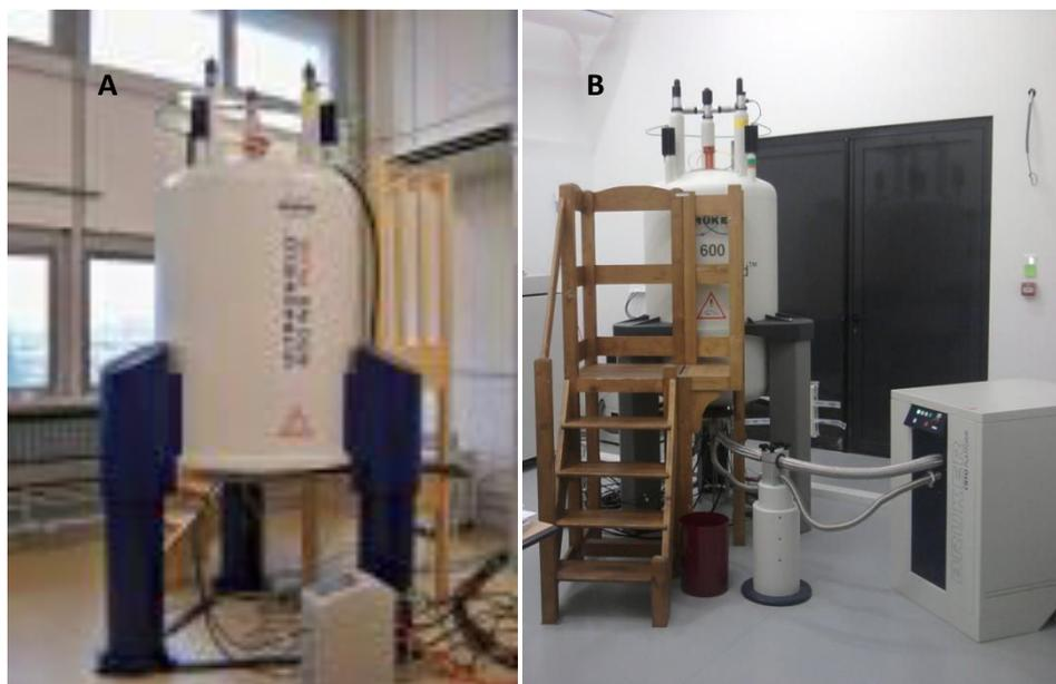
Figure II.5 : A) Bruker Avance III 600 MHz wide bore, spectromètre équipé pour la RMN haute résolution multi-noyaux, valeur du champ magnétique: 14.1T, fréquence de résonance du proton: 600 MHz, il se trouve dans le service commun de RMN de la faculté des sciences, et est géré par l'équipe de Méthodologie RMN (RMN) du laboratoire de cristallographie, Résonance Magnétique et Modélisations, UMR CNRS 7036.
