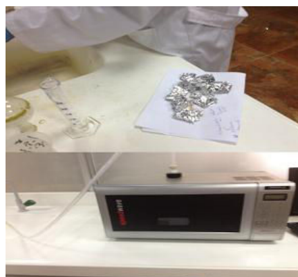
Photo 1A: Préparation des échantillons, digestion et mesure des sédiments
