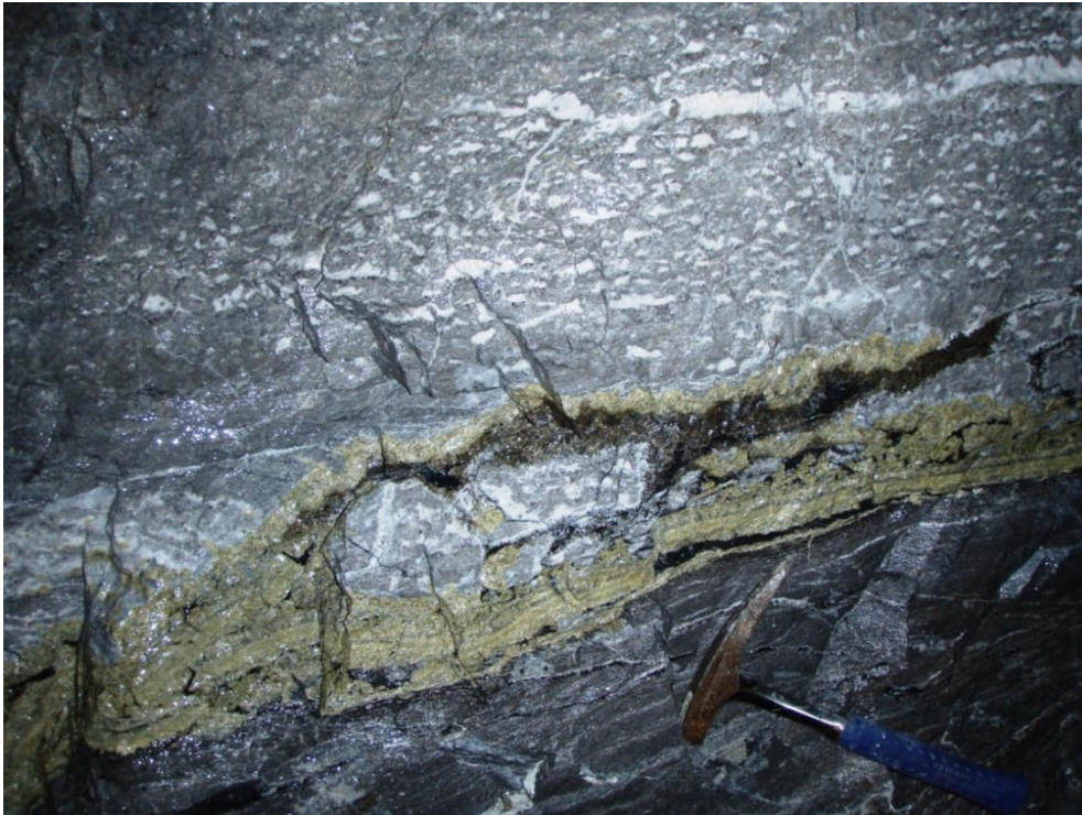
Fig. 16. Filon minéralisé dans la mine Coy (ET) avec la présence de sphalérite brune et de sphalérite jaune.
