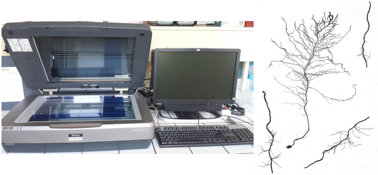
Figure 16 – Photographie du scanner adapté à l'utilisation du logiciel d'analyse d'image WinRhizo® Reg et image d'un système racinaire de maïs de 28 jours cultivé sur du sable non contaminé.
