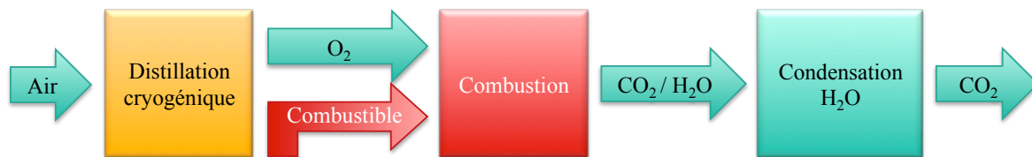
Figure I. 5 : Schéma du principe de l'oxy-combustion.
