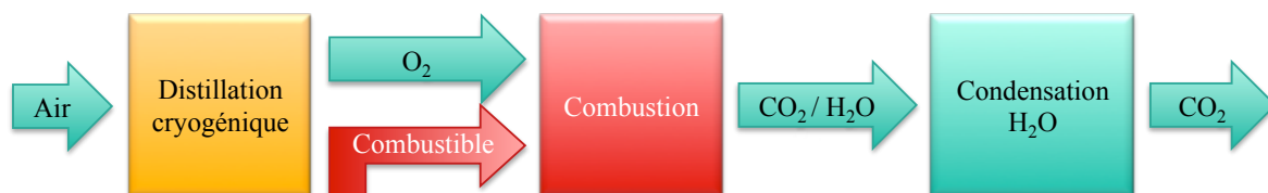
Figure I. 5 : Schéma du principe de l'oxy-combustion.
