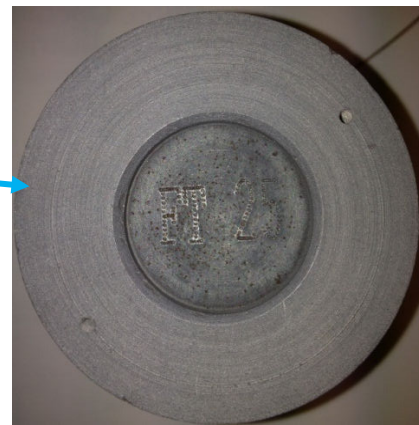
Figure 6.12 : Echantillon présentant un défaut d'uniformité d'émissivité.
