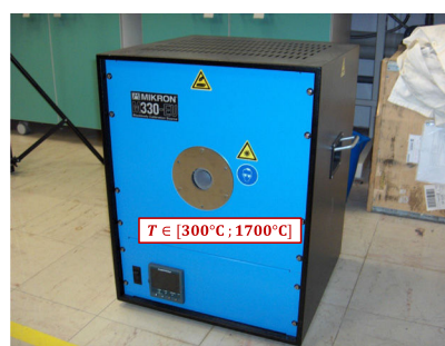
Figure 7.4 : Corps noir à cavité.
