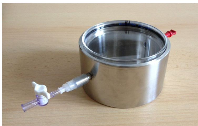
Figure 4.1. Réacteur pour la dégradation du toluène en système fermé.
