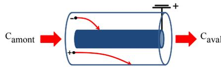
FIGURE 2.19 – Principe de fonctionnement du précipitateur électrostatique.
