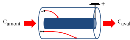
FIGURE 2.19 – Principe de fonctionnement du précipitateur électrostatique.
