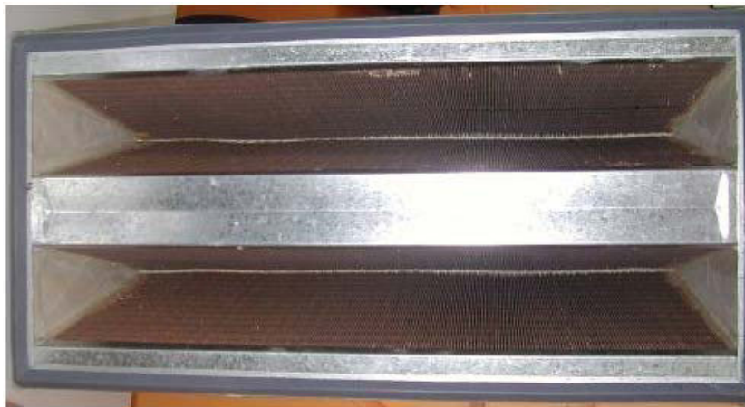
Figure 2 : Photo d'un filtre THE industriel (double dièdres)
