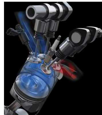
Figure 0.2 : Illustration d'une chambre de combustion d'un moteur automobile à injection directe.
