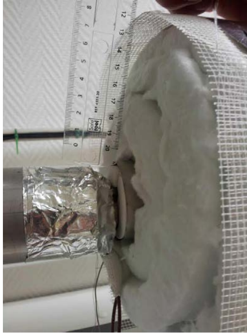
Figure 17. Isolation Kerlane du tube de refroidissement 300K/s
