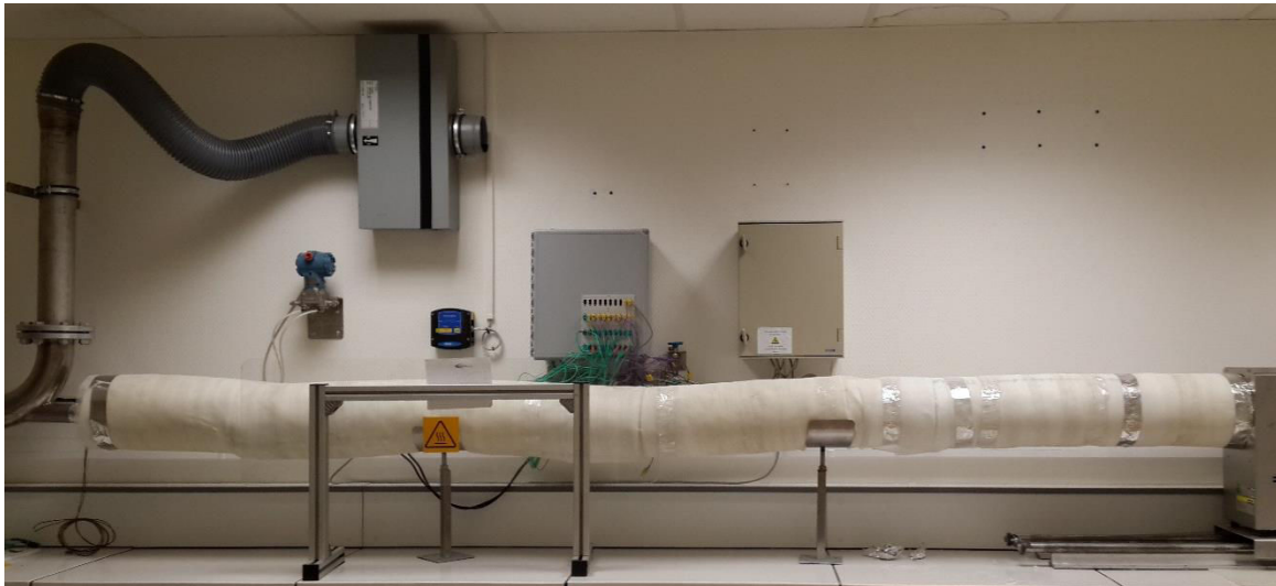
Figure 14. Tube de refroidissement pour une cinétique de 300K/s.
