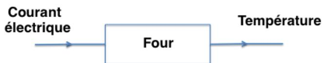
FIGURE 5.1 – Représentation d'un contrôle à boucle ouverte
