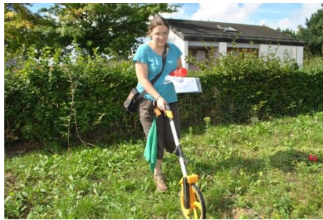
Figure 29: Mesure des dimensions d'un jardin à l'aide d'une roue de mesure (Eglantiers, Nantes) (Rakoto, 2012)
