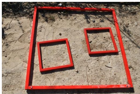
Figure 30: Quadrats de 30cm de côté et quadrat de 1m 2 (Joimel, 2013)
