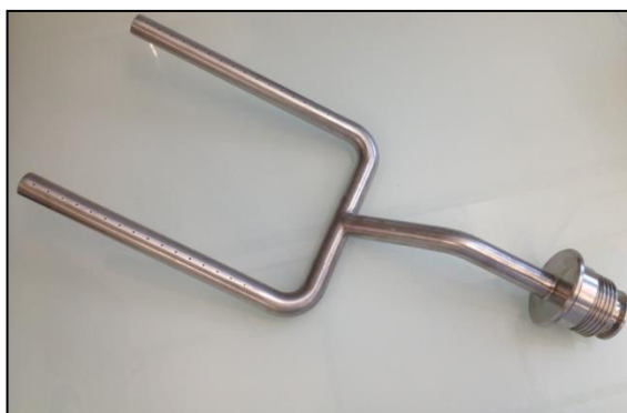
Figure 18. Photographie du sparger classique pour le fermenteur de 900L
