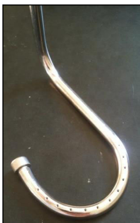
Figure 17. Photographie du sparger classique en fer à cheval pour le fermenteur de 2L
