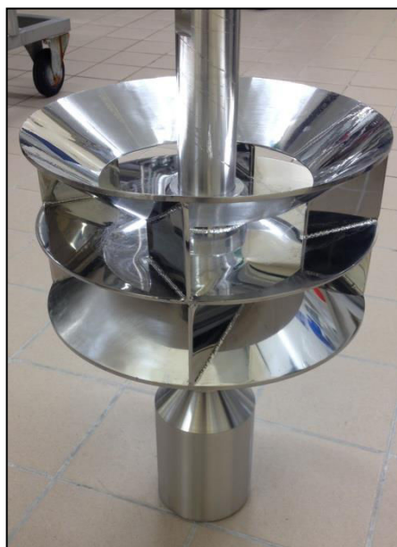
Figure 12. Photographie de la turbine centripète pour le fermenteur de 900L
