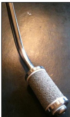
Figure 19. Photographie du microsparger 40µm pour le fermenteur de 2L
