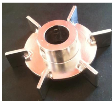
Figure 9. Photographie d'une turbine Rushton pour le fermenteur de 2L
