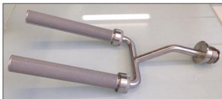
Figure 20. Photographie de la membrane de filtration porosité 20µm (à gauche) et du microsparger (à droite) pour le fermenteur de 900L
