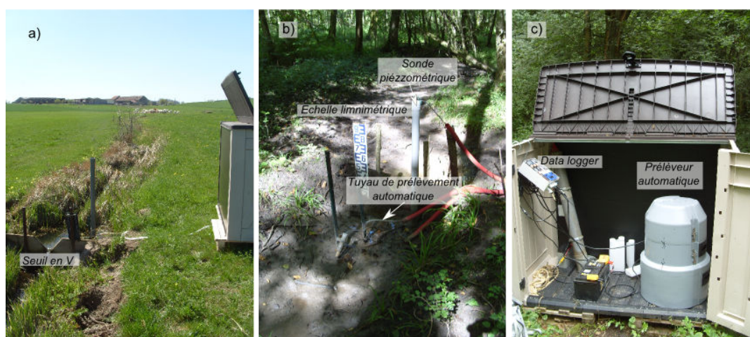
Figure 2.12. Installations pour la mesure de débit et de concentration dans les ruisseaux. a) Seuil en V ; b) ruisseau à sec où l'on voit l'installation de la sonde piézométrique (mesure de hauteur d'eau) et le tuyau de prélèvement automatique ; c) Cabane avec l'enregistreur de données, le préleveur automatique et leur alimentation.
