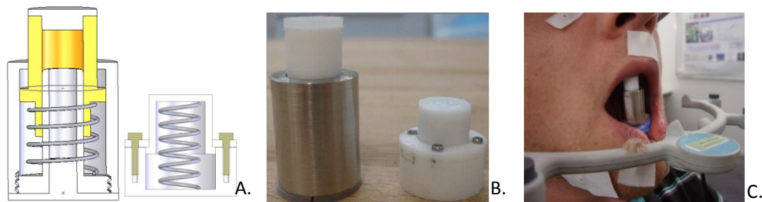
Figure III.8- A- Schéma de la conception des dynamomètres. B-Dynamomètres utilisés. C-Mise en place du dynamomètre incisif.
