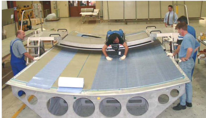
Figure 1.22 Stratification d'une partie de fuselage d'A380 en Glare (Beumler, 2009)
