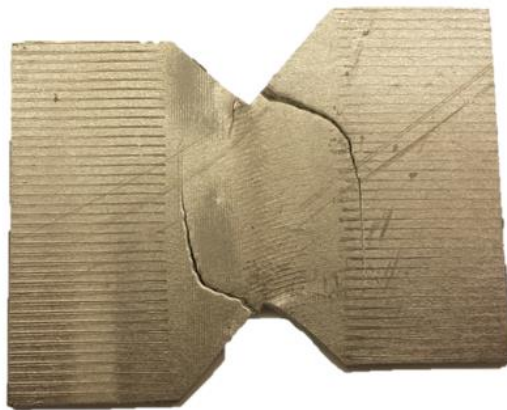
Figure 4.22 Epreuve de cisaillement post-mortem en Glare 5-2
