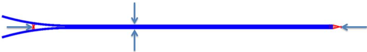
Figure 3.47 Modèle EF de flambage de l'éprouvette de délaminage dynamique
