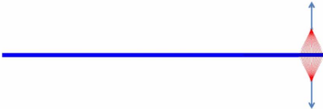
Figure 3.40 Modèle EF de l'essai de DCB
