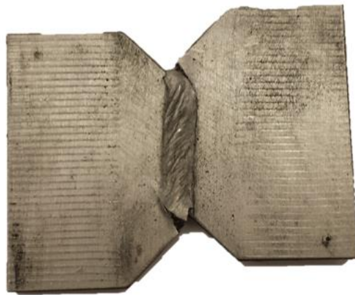
Figure 4.4 Éprouvette de cisaillement post-mortem en Carall 5-2 tissé
