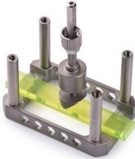
Figure 3.35 Représentation de l'essai de flexion trois points de la DMA
