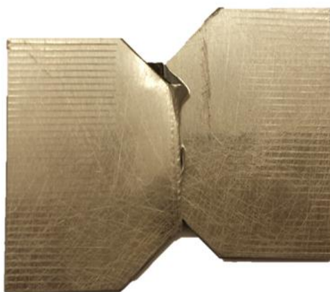
Figure 4.13 Epreuve de cisaillement post-mortem en Carall 5-2 UD
