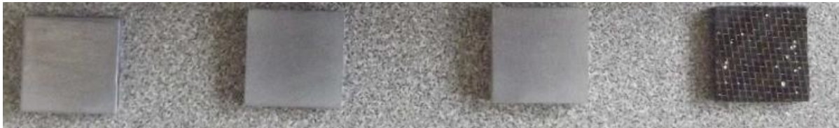
Figure 3.52 Eprouvettes de mesures de conductivité thermique plaque chaude gardée (de gauche à droite : Carall 5-2 tissé, Carall 5-2 UD, Glare et Carbone + BM)
