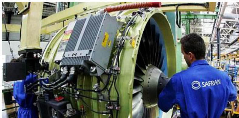
Figure 1.10 Installation d'un FADEC sur un réacteur
