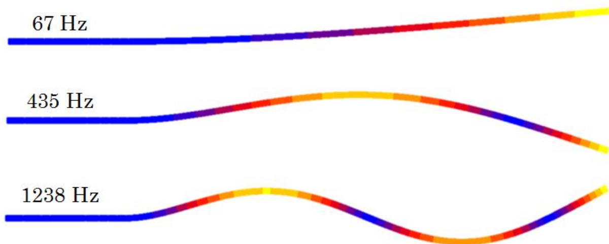
Figure 3.25 Résultats de l'analyse modale avec les trois premières formes propres en flexion
