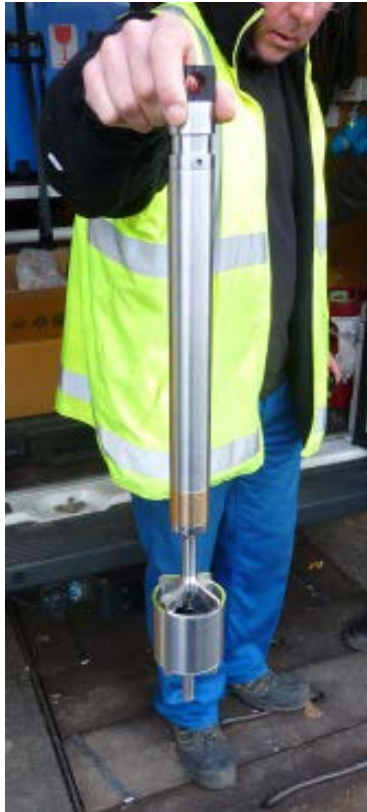
Figure 9 - Moulinet utilisé pour la mesure de vitesses moyennes dans le puits Vouters 2
