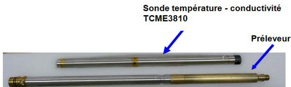
Figure 7 – Sonde de température et conductivité électrique de l'eau TCME3810 utilisée durant les campagnes de mesures.
