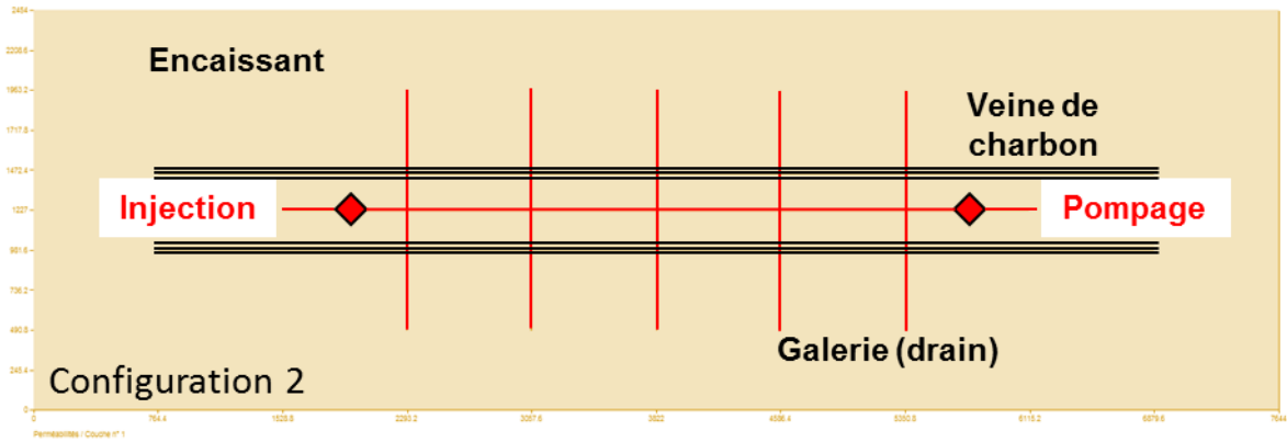
Figure 86 - Schéma de la configuration 2 utilisée pour tester les drains-conduits en 2D avec un domaine de 2,5 km de long par 7,5 km de large.
