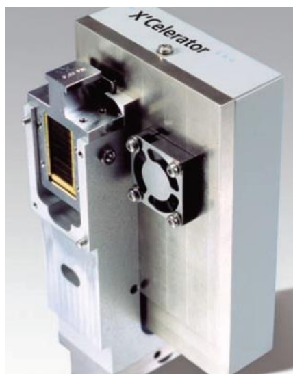
Figure 1.39 : Détecteur PANalytical X'celerator pour diffractomètre à poudre.
