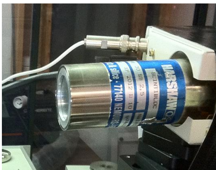
Figure 1.13 : Diffractomètre Enraf-Nonius CAD4 avec à gauche son détecteur ponctuel à scintillation.
