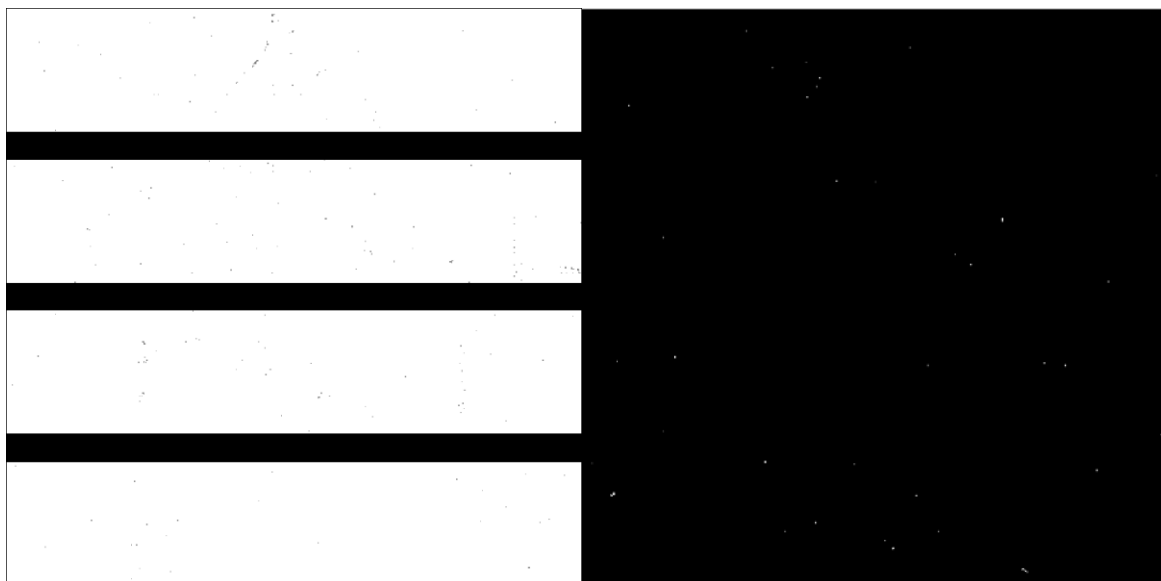
Figure 2.14 : Image 'blanche' et image 'noire' obtenues respectivement en éclairant XPAD de façon uniforme avec un diffuseur (à gauche) et au contraire en protégeant XPAD de toutes radiations parasites (à droite).
