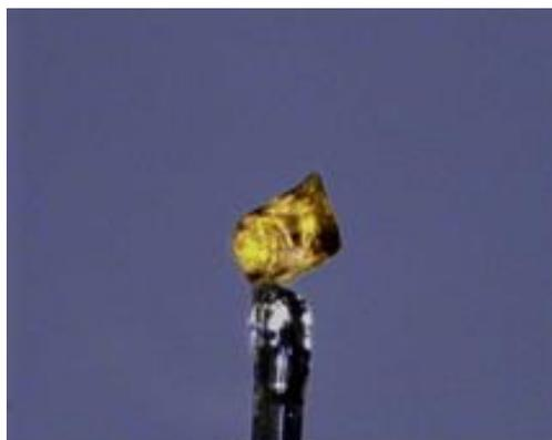
**Figure 4.2** : Photographie au microscope du monocristal de SNP utilisé pour cette étude et monté sur une tige en silice.
