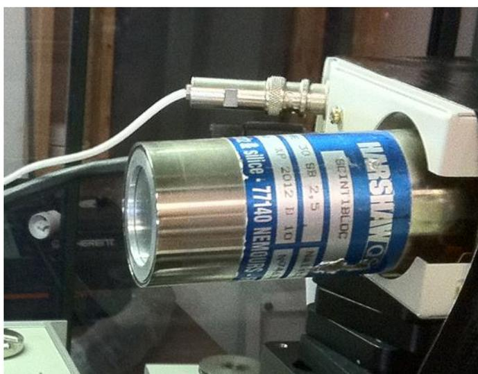
**Figure 1.14** : Détecteur ponctuel à scintillation du diffractomètre Bruker-Nonius Mach3. Le mécanisme de fentes automatiques a été retiré pour permettre une meilleure vue.
