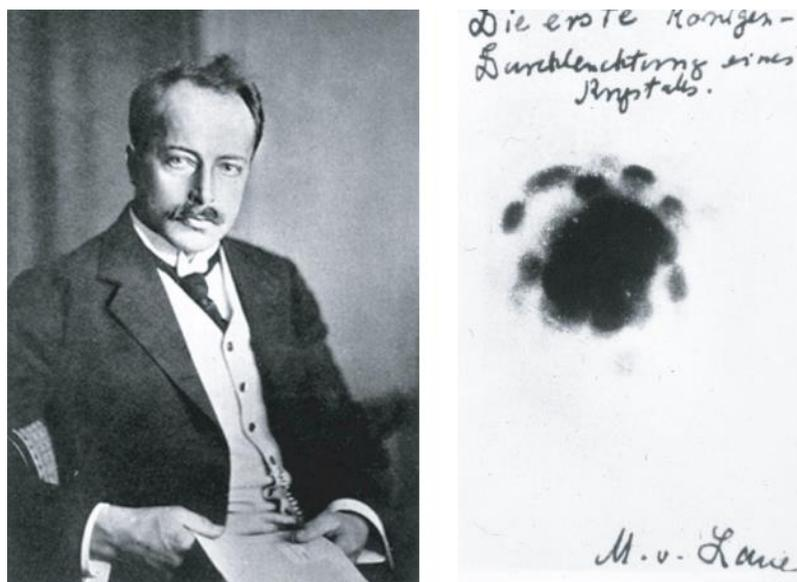
**Figure 1.2** : Max Von Laue (1879-1960) et à droite le premier cliché de diffraction des rayons X sur un cristal de sulfate de cuivre (1912)
