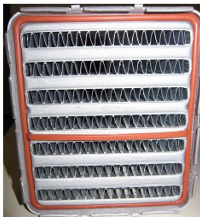
Figure2.42: Géométrie de l'échangeur TBT côté gaz
