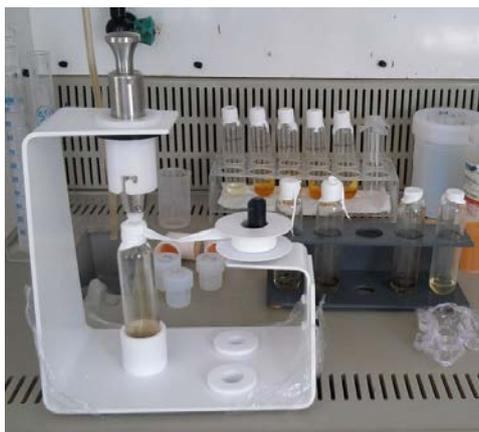
Figure 26. Fermeture des tubes en quartz
