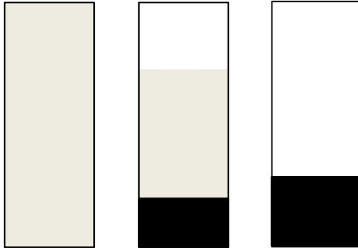
FIGURE I.5 – Schématisation du phénomène de sédimentation en colonne : la suspension, de fraction volumique initiale  $\alpha_0$  (en gris) est uniformément répartie dans un fluide au repos. Lorsque les particules sédimentent on distingue trois domaines : un domaine fluide (blanc), un domaine ayant la même fraction volumique initiale (gris) et le fond (en noir) qui a atteint la fraction volumique maximale. A la fin du processus, toutes les particules sont sur le fond.
