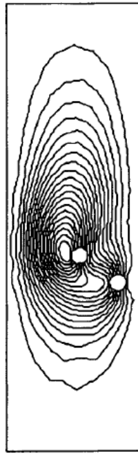
FIGURE V.3 – Sédimentation de deux particules : structure stationnaire en doublet oblique pour deux particules à un nombre de Reynolds terminal de chute R_{eT} = 1.78 et un confinement W/D = 8 . D'après Feng et al. (1994)
