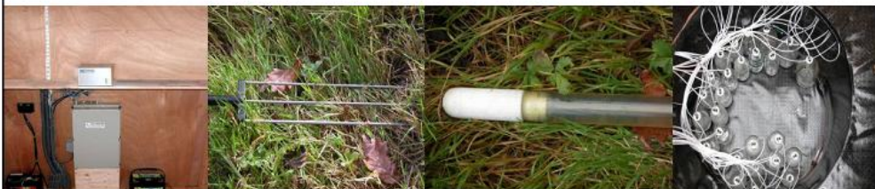
Mesure de l'humidité du sol et prélèvement de solutions du sol
