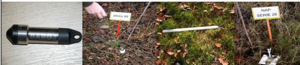
Mesure de niveau de nappe et capteur d'eaux libres
