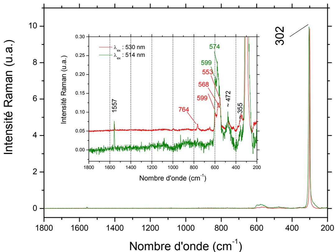
Figure III.1 : Spectres Raman de deux supports en germanium enregistrés avec une longueur d'onde d'excitation ( $\lambda_{\text{ex}}$ ) respectivement de 514 (réseau à 1200 traits) et 530 nm (réseau à 1800 traits). Les spectres sont normés par rapport à la bande à 302  $\text{cm}^{-1}$ . Encart : agrandissement des bandes de faible intensité
