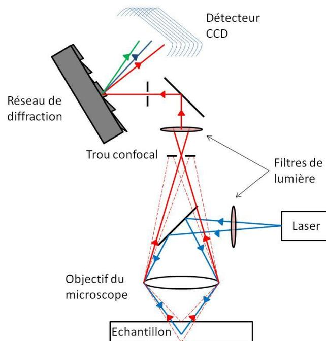
Figure II.7 : Descriptif d'un microspectromètre Raman confocal
