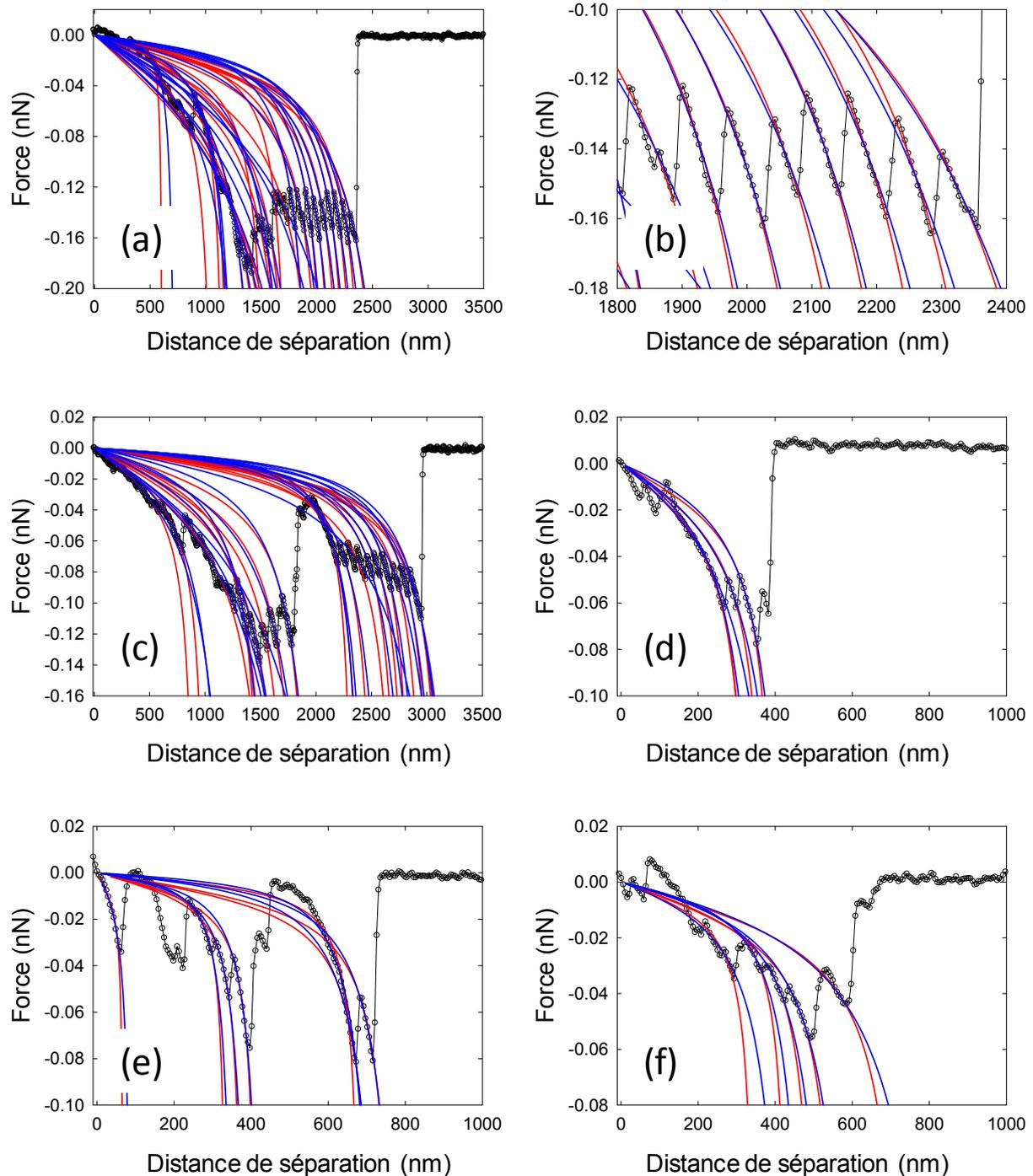
Figure IV.15 : Courbes de force expérimentales représentatives (courbes de retrait) enregistrées en utilisant une sonde fonctionnalisée avec la ConA sur un biofilm de *P. fluorescens* de 24 h. Les courbes rouges et bleues correspondent à l'ajustement des courbes expérimentales selon les modèles théoriques FJC et WLC respectivement. (a, b, c) Exemples
