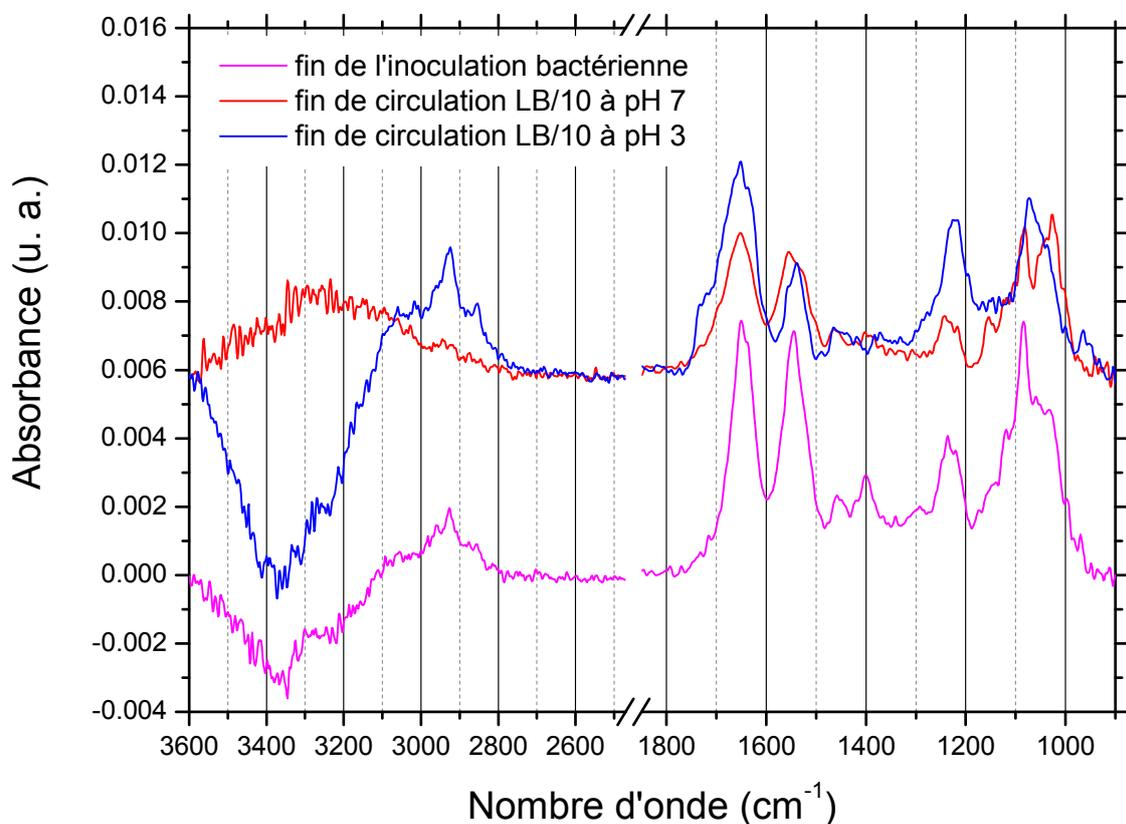
Figure V.14 : spectres IR-ATR de jeunes biofilms d'*E. coli* de 24h formés sous circulation du milieu LB/10 à pH 7 et 3 comparés au spectre à la fin des 3h d'inoculation bactérienne. Cristal ATR en germanium. Le spectre pris comme référence pour les deux spectres à la fin de la circulation de LB/10 est celui enregistré au début de cette circulation.
