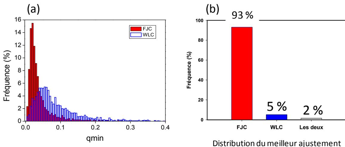
Figure V.9 : (a) Distribution des  $q_{min}$  calculés pour les modèles FJC et WLC, (b) distribution du meilleur ajustement par FJC et WLC. Les deux modèles sont considérés équivalents quand la différence de la qualité d'ajustement est inférieure à 5%.
