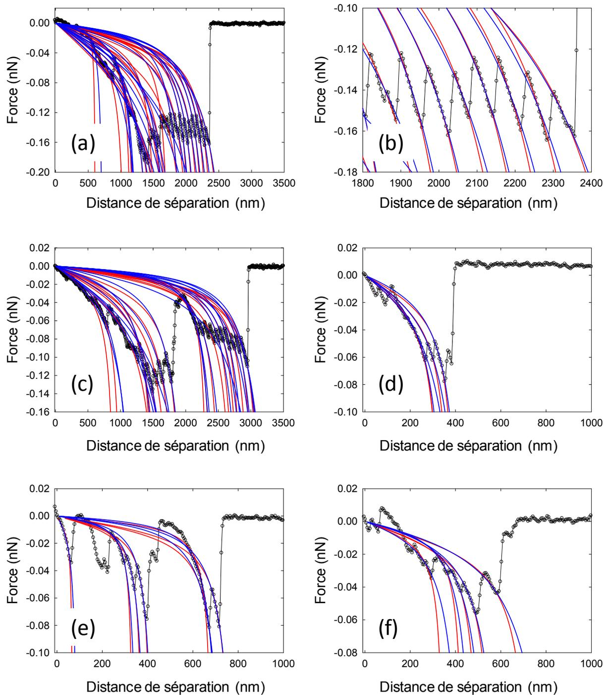
Figure V.8 : (a, c-f) Courbes de force expérimentales représentatives (courbes de retrait) enregistrées en utilisant une sonde fonctionnalisée avec la ConA sur un biofilm de *P. fluorescens* de 24 h formé à pH 3, (b) agrandissement d'une région d'intérêt. Les courbes de force correspondent aux différentes régions d'un même biofilm. Les courbes rouges et bleues correspondent à l'ajustement de ces courbes respectivement selon les modèles théoriques FJC et WLC.
