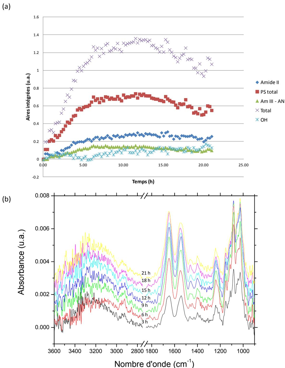
Figure IV.23 : (a) Evolution des aires intégrées des principales bandes IR au cours de la circulation de LB/10. (b) Evolution du profil spectral IR d'un biofilm d'*E. coli* à la surface d'un cristal Ge après 3, 6, 9, 12, 15, 18 et 21 h de circulation du milieu nutritif LB/10. La référence des spectres est le spectre acquis au début de la circulation du milieu LB/10.
