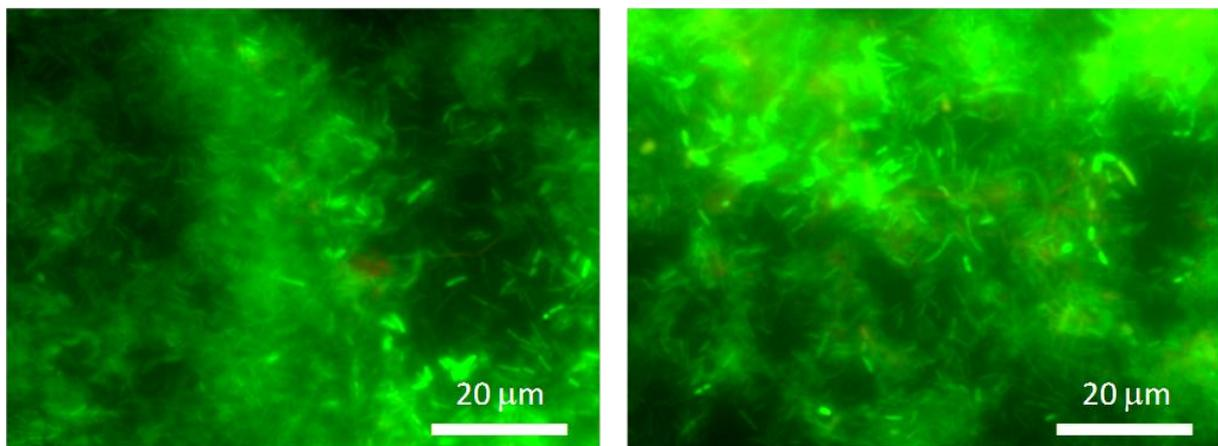
Figure IV.5 : Images représentatives par microscopie à épifluorescence d'un biofilm de 24 h de *P. fluorescens*, suite au test *Baclight*<sup>TM</sup>. Les deux images correspondent à deux zones différentes du cristal ATR
