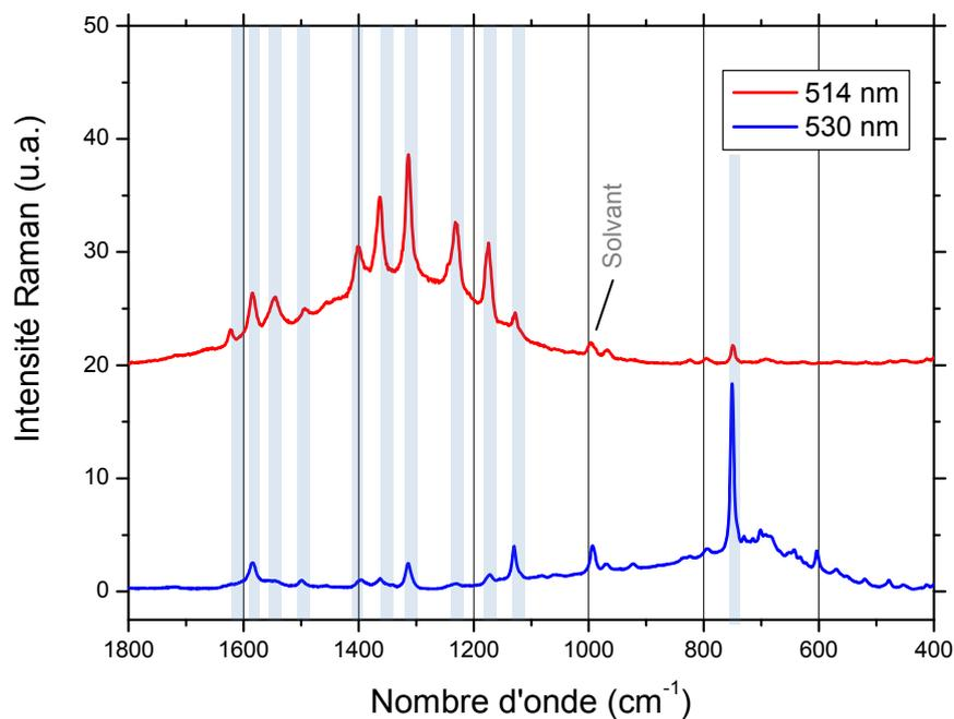
Figure III.7 : Spectres Raman du cytochrome *c* (forme réduite) de cœur de bœuf obtenus respectivement à 514 (en haut, réseau à 1200 traits) et 530 nm (en bas, réseau à 1800 traits)
