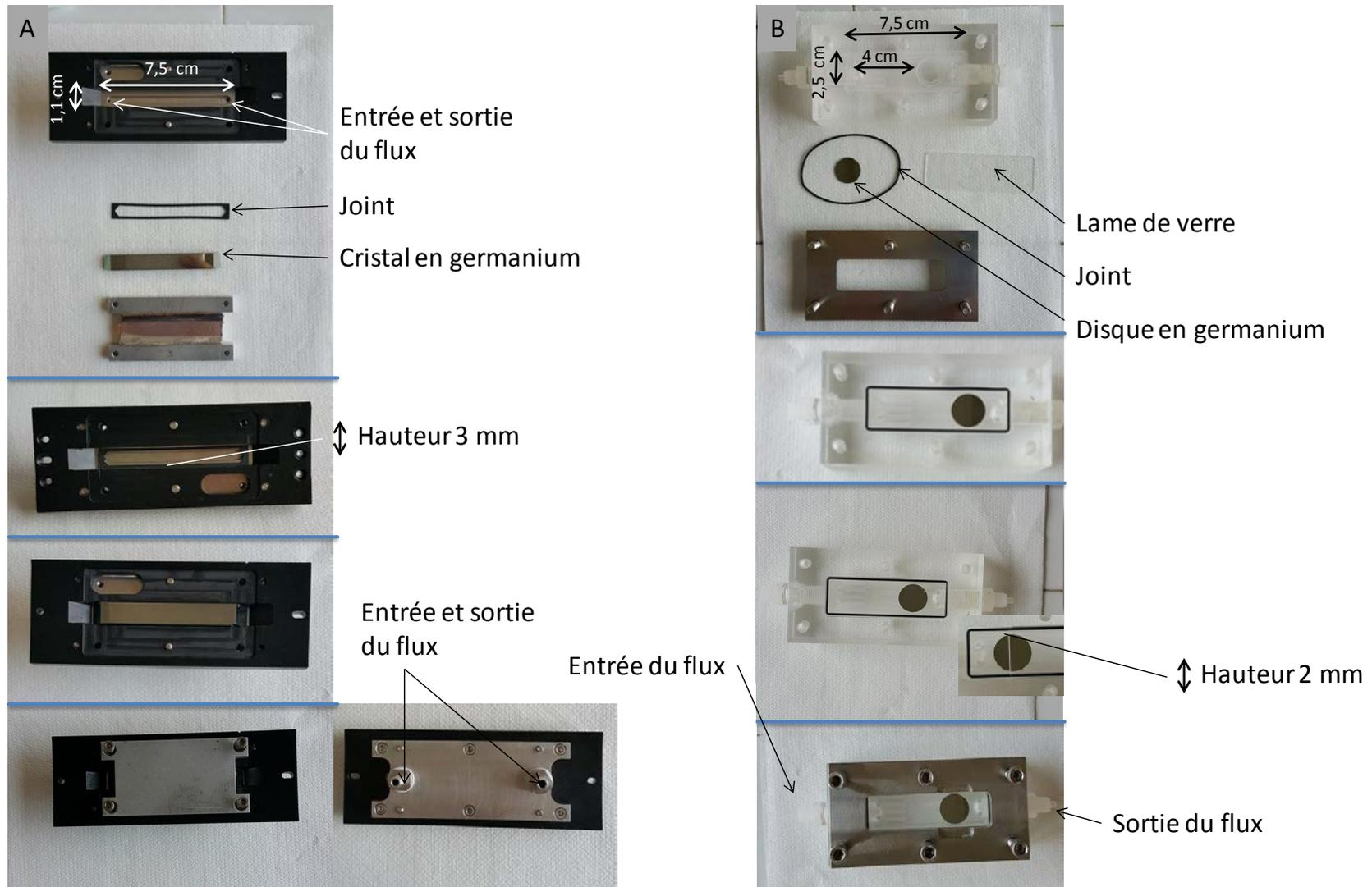
Figure II.2 : photos montrant l'assemblage et les dimensions de cellules d'écoulement utilisées pour la formation des biofilms destinés aux analyses (A) *in situ* et en temps réel en spectroscopie FTIR-ATR et (B) aux analyses par spectroscopie Raman et AFM, la hauteur indiquée correspond à la hauteur de la chambre d'écoulement.
