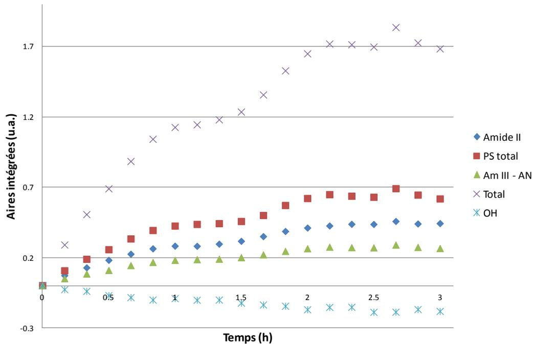
Figure IV.3 : Evolution des aires intégrées des principales bandes des spectres IR-ATR acquis au cours de la circulation de  $S_{0-Pf}$ . Cristal ATR en germanium. Amide II  $1600-1480\text{ cm}^{-1}$ , PS (polysaccharides) total  $1195-950\text{ cm}^{-1}$ , AmIII-AN (Amide III - acides nucléiques)  $1340-1180\text{ cm}^{-1}$ , total  $1800-950\text{ cm}^{-1}$ , OH  $3600-3400\text{ cm}^{-1}$
