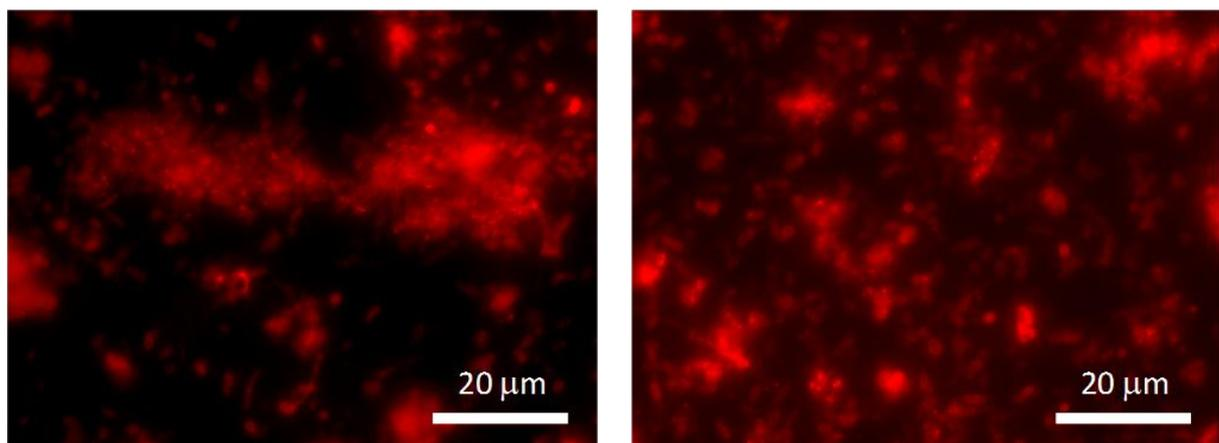
Figure V.16 : Images représentatives par microscopie à épifluorescence d'un biofilm d'*E. coli* de 24 h formé à pH 3, marqué par la WGA Alexa Fluor 895 spécifique de N-acétylglucosamine et de l'acide sialique. Les deux images correspondent à deux endroits du cristal
