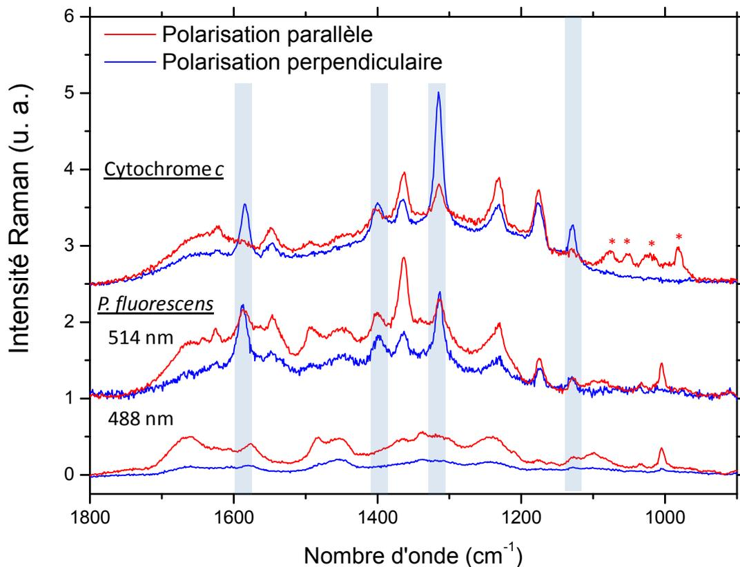
Figure III.10 : Spectres Raman polarisés d'un culot semi-hydraté de *Pseudomonas fluorescens* ( $\lambda_{\text{ex}}$  : 514 et 488 nm) et de cytochrome *c* du cœur bovin. Les bandes sur fond gris sont les bandes présentant une polarisation inverse, réseau à 1200 traits, \* : bandes du solvant
