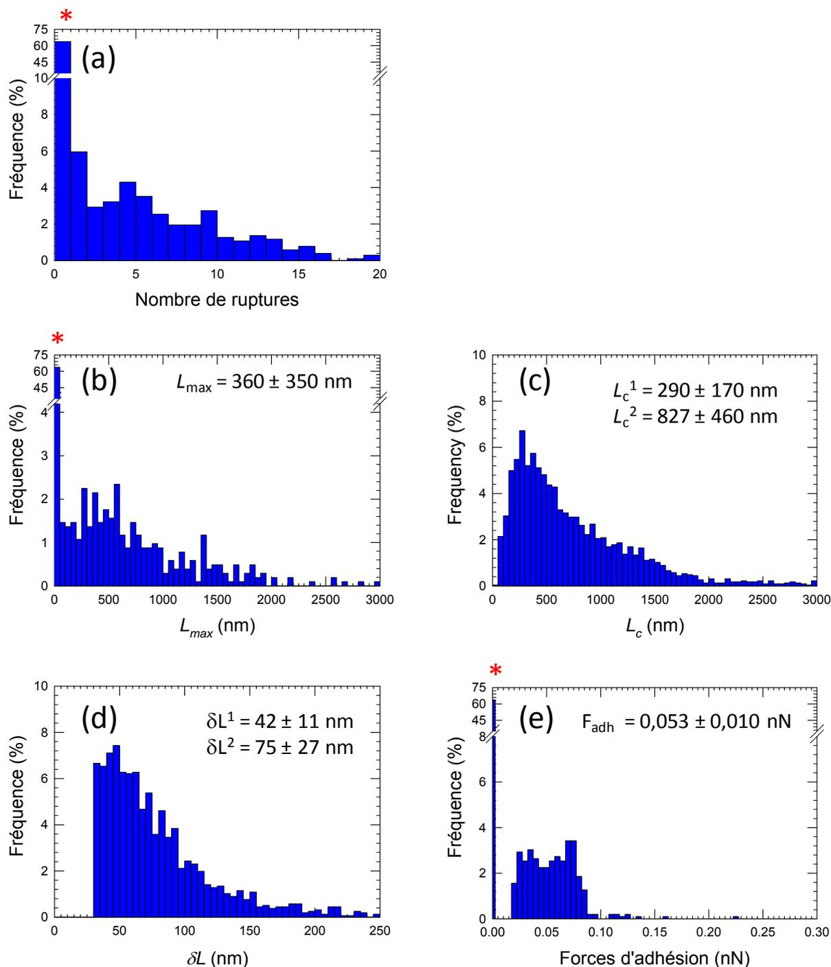
Figure V.10 : Propriétés conformationnelles des exopolymères riches en glucose d'un biofilm de *P. fluorescens* de 24 h formé en milieu LB/50 à pH 3. Les distributions statistiques sont obtenues à partir des données enregistrées par SMFS avec des sondes fonctionnalisées avec la ConA : (a) nombre de ruptures, (b)  $L_{max}$ , (c)  $L_c$ , (d)  $\delta L$ , (e) forces d'adhésion, \* : pourcentage à zéro = 63 %
