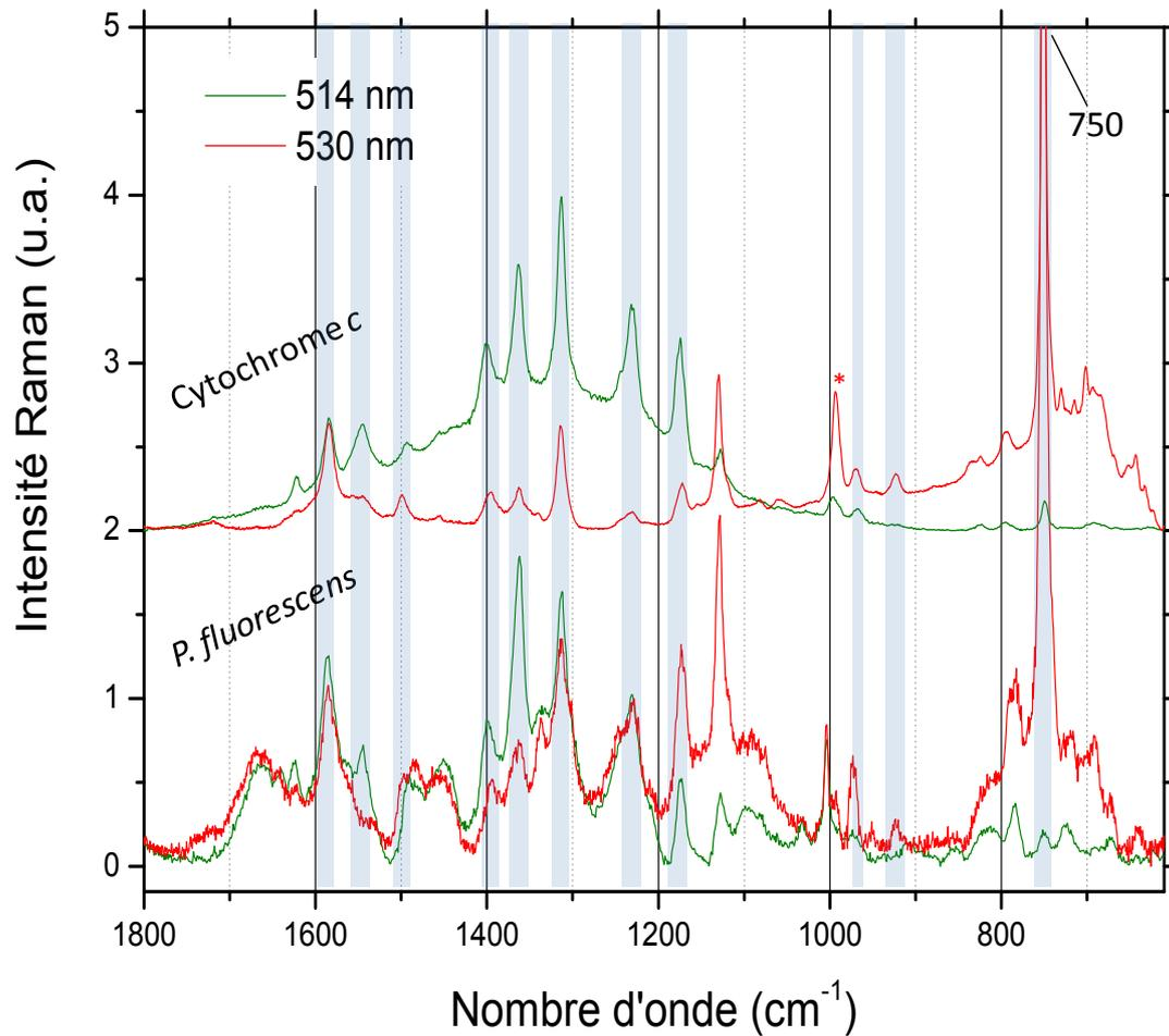
Figure III.4 : Spectres Raman du cytochrome *c* bovin et d'un culot de bactéries *P. fluorescens* planctoniques en phase exponentielle,  $\lambda_{\text{ex}}$  : 514 (vert), 530 (rouge), réseau à 1800 traits (sauf pour le spectre du cytochrome *c*,  $\lambda_{\text{ex}}$  514 nm, réseau à 1200 traits), \* : sel présent dans le solvant
