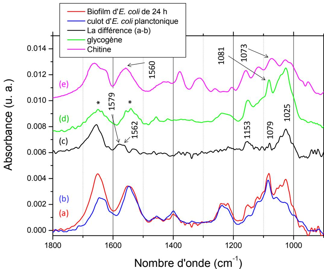
Figure IV.26 : Spectres IR-ATR (a) d'un biofilm d'*E. coli* de 24 h (crital ATR en germanium), (b) d'un culot partiellement hydraté de bactéries d'*E. coli* planctoniques collectées en fin de phase exponentielle (accessoire ATR en diamant), (c) la différence (a-b) et (d) du glycogène, solution de 5g/L (accessoire ATR en diamant). (e) Spectre IR (en transission) de la chitine \* impuretés protéiques dans le glycogène commercial. Les spectres a et b sont normés par rapport à la bande Amide II.
