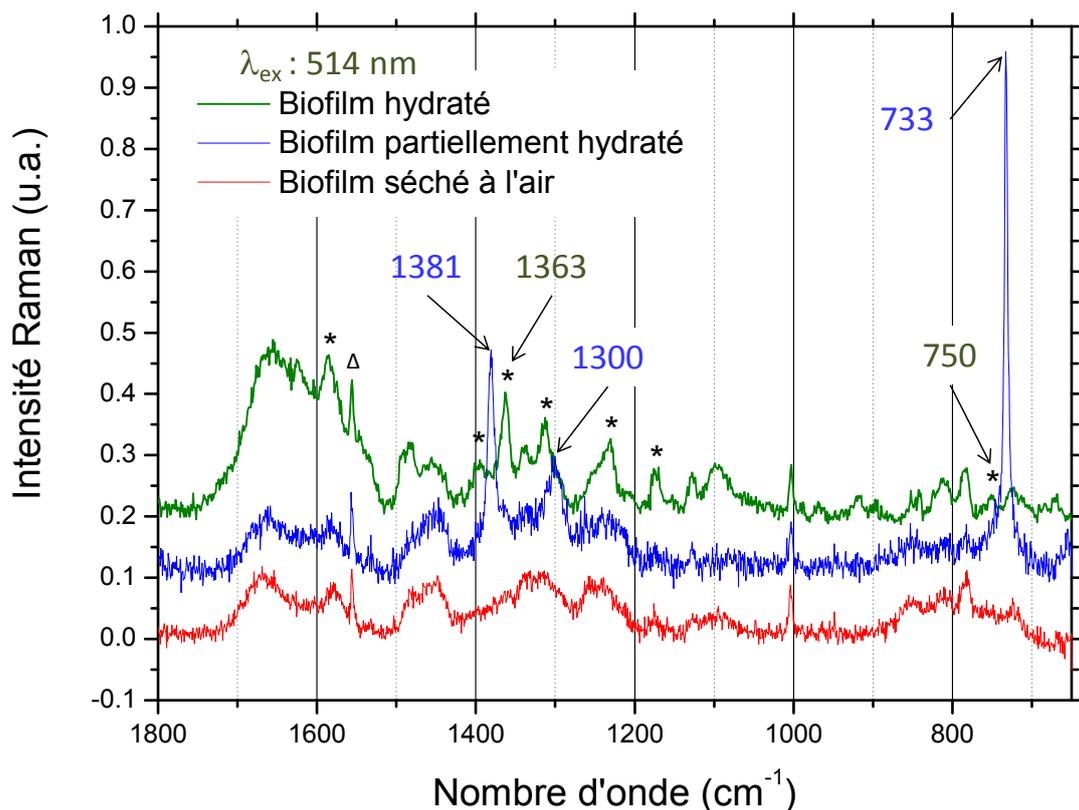
Figure IV.9 : Spectres Raman sous différents états d'hydratation d'un biofilm de *P. fluorescens* de 21 h : hydraté (vert, en haut), partiellement hydraté (bleu, au milieu) et séché à l'air (rouge, en bas), les spectres sont normés par rapport à la bande de la phénylalanine à  $1003 \text{ cm}^{-1}$  (\* : bandes attribuées au cytochrome *c*,  $\Delta$  : vibration de l' $\text{O}_2$ ), réseau à 1200 traits,  $\lambda_{\text{ex}}$  : 514 nm
