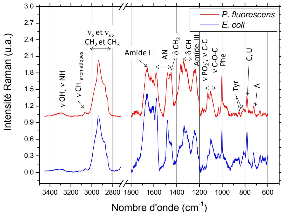
Figure III.2 : Spectres Raman de culots partiellement hydratés de bactéries *P. fluorescens* (en haut) et *E. coli* (en bas) planctoniques collectées en phase exponentielle, les spectres sont normés par rapport à la bande à  $1003\text{ cm}^{-1}$  de la phénylalanine,  $\lambda_{\text{ex}}$  : 488nm, (C : cytosine, A : adénine, U : uracile, Phe : phénylalanine, Tyr : tyrosine, AN : acides nucléiques,  $\nu$  : vibration d'élongation,  $\delta$  : vibration de déformation), réseau à 1200 traits.
