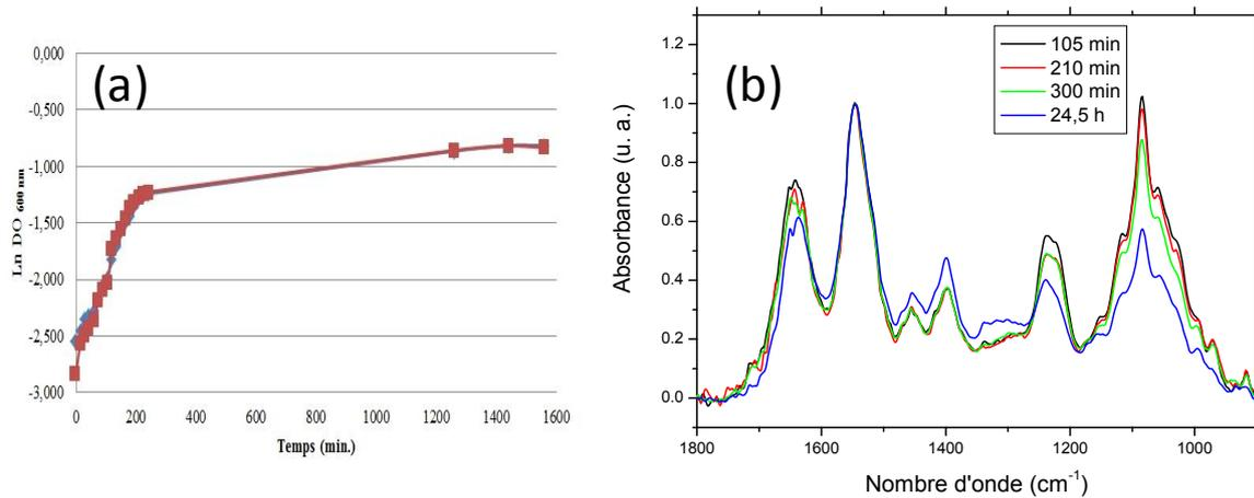
Figure IV.20 : (a) Courbe de croissance de la souche *E.coli* UGB 3152 dans du milieu LB/10, (b) Spectres IR sur un cristal en diamant de culots bactériens d'*E. coli* en phase exponentielle (105 min), phase stationnaire (210, 300 min) et phase de déclin (24 h), cultivés dans du milieu LB/10, les spectres sont normés par rapport à la bande amide II
