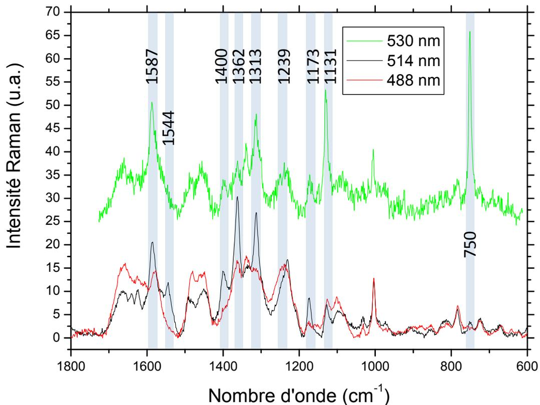
Figure III.3 : Signatures spectrales Raman d'un culot de bactéries *P. fluorescens* planctoniques aux longueurs d'onde d'excitation 488, 514 (réseau à 1200 traits) et 530 nm (réseau à 600 traits). Les bactéries ont été collectées en phase exponentielle et les spectres sont normés par rapport au pic à 1003 cm<sup>-1</sup> attribué à la phénylalanine.
