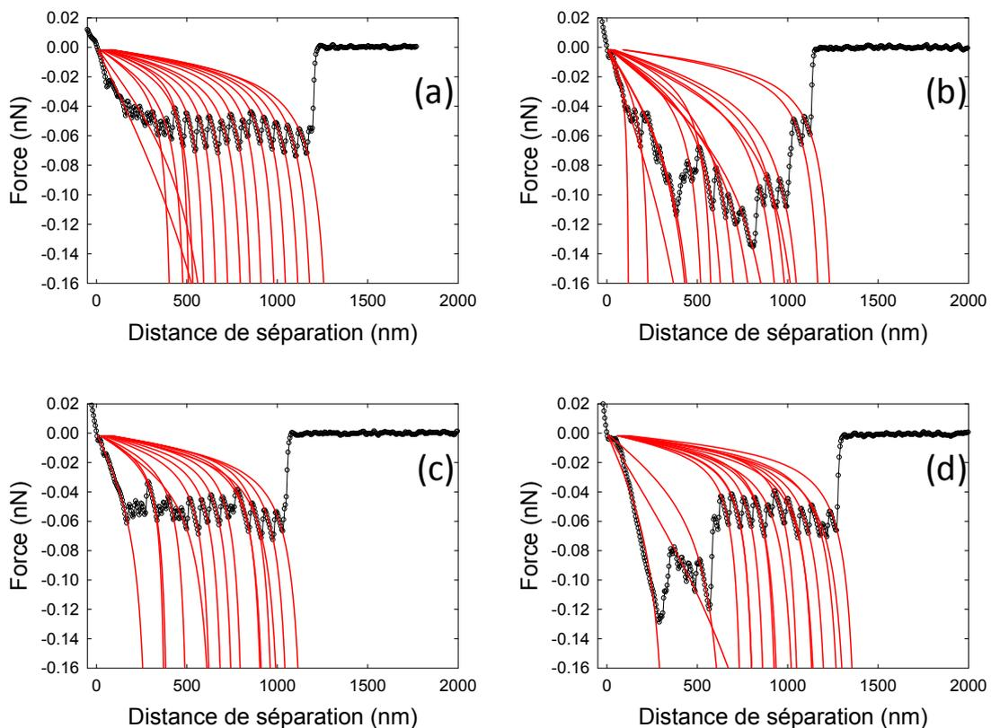
Figure IV.14 : Courbes de force expérimentales représentatives (courbes de retrait) obtenues à différents endroits d'un biofilm de *P. fluorescens* de 24 h en utilisant une sonde fonctionnalisée avec la ConA.
