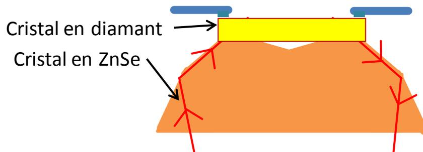
Figure II.6 : Schéma de l'accessoire ATR diamant
