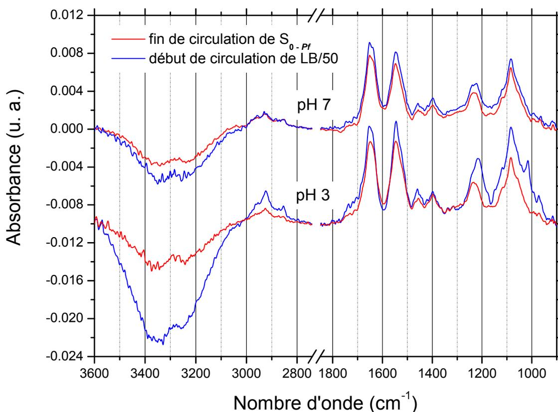
Figure V.1 : Spectres IR-ATR d'un très jeune biofilm de 3h de *P. fluorescens* enregistrés à la fin de circulation de la suspension  $S_{0-Pf}$  (trait rouge) et au début de circulation de LB/50 (trait bleu) au pH 7 (3h et 42 minutes) et 3 (3h et quelques minutes). Cristal ATR en germanium. Le spectre de référence est le premier spectre enregistré suite à la circulation de la suspension  $S_{0-Pf}$ .
