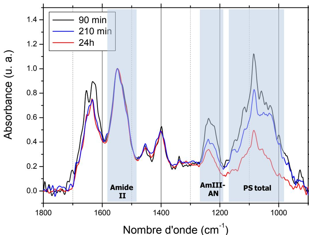
Figure IV.19 : Spectres IR-ATR enregistrés sur un cristal en diamant de culots bactériens d'*E. coli* en phase exponentielle (90 min), phase stationnaire (210 min) et phase de déclin (24 h), cultivés dans du milieu LB 25 g/L. Les spectres sont normés par rapport à la bande Amide II.
