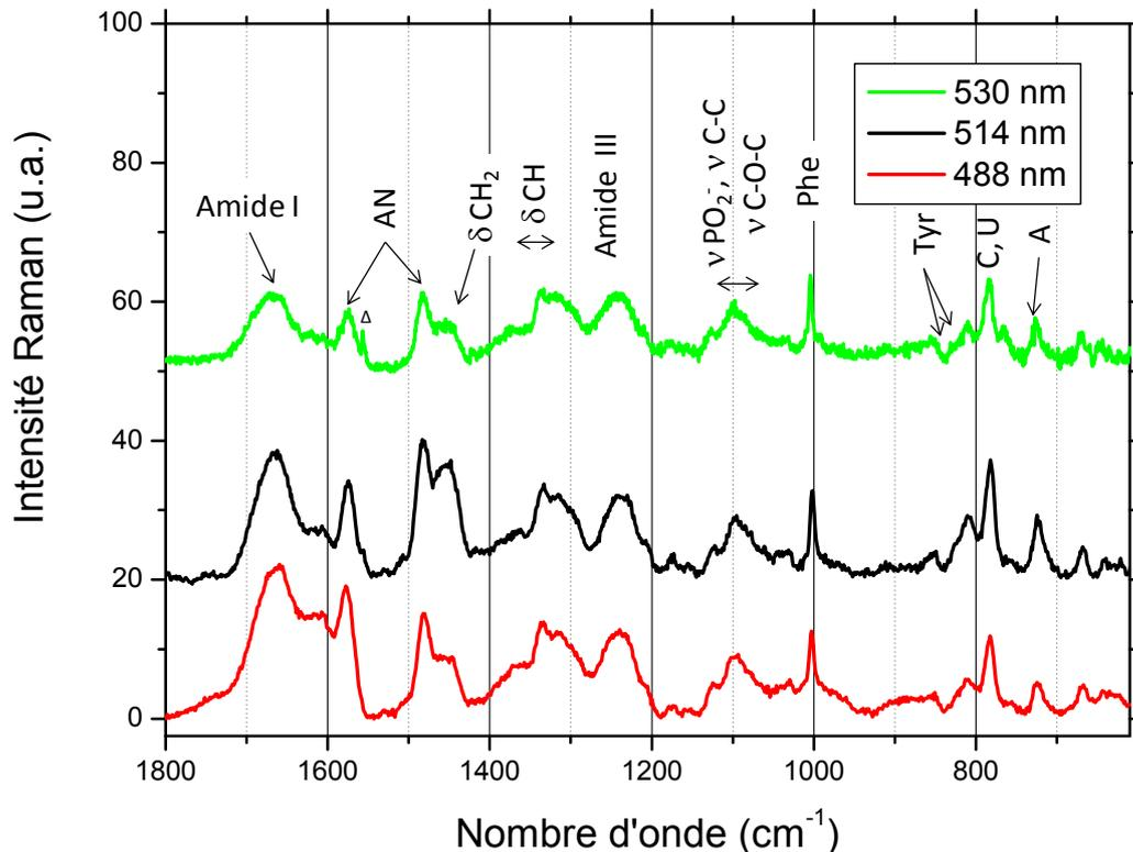
Figure III.8 : Spectres Raman d'un culot partiellement hydraté de bactéries *E. coli* planctoniques collectées en phase exponentielle,  $\lambda_{\text{ex}}$  : 488 (rouge, en bas, réseau à 1800 traits), 514 (noir, au milieu, réseau à 1200 traits) et 530 nm (vert, en haut, réseau à 1800 traits). Les spectres sont normés par rapport à la bande de phénylalanine à  $1003 \text{ cm}^{-1}$ ,  $\Delta$  : vibration de l' $\text{O}_2$
