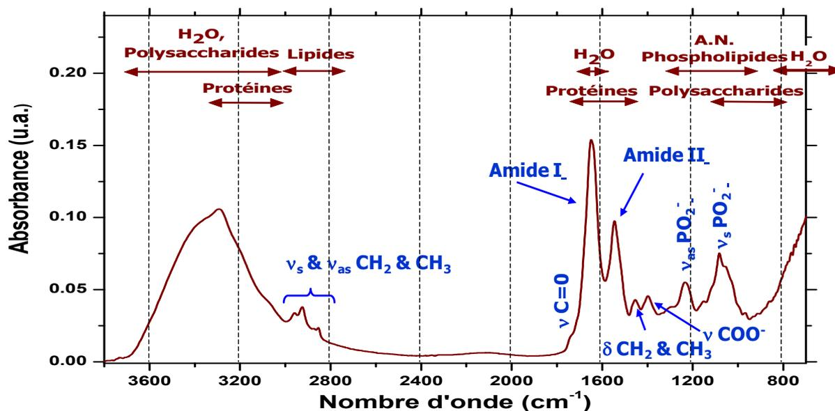
Figure IV.1 : Spectre IR-ATR typique d'un culot partiellement hydraté de bactéries *P. fluorescens* planctoniques collectées en fin de phase exponentielle. Cristal ATR en germanium (A.N : acides nucléiques)
