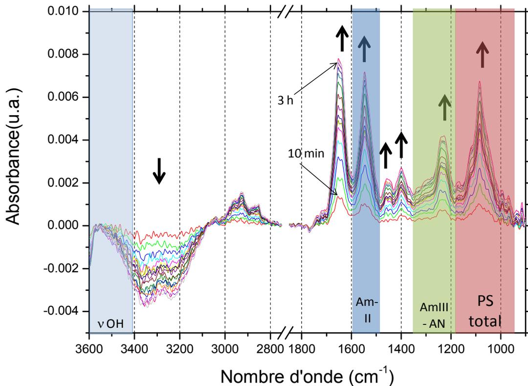
Figure IV.2 : Evolution du profil spectral IR-ATR au cours de la circulation de  $S_{0-Pf}$ . Cristal ATR en germanium. Bornes d'intégration de bandes IR d'intérêt :  $\nu$ OH 3600-3400  $\text{cm}^{-1}$  (zone bleu claire), AmII (amide II) 1600-1480  $\text{cm}^{-1}$  (zone bleu foncée), AmIII-AN (amide III et acides nucléiques) 1340-1180  $\text{cm}^{-1}$  (zone verte), PS (polysaccharides) total 1195-950  $\text{cm}^{-1}$  (zone rouge)
