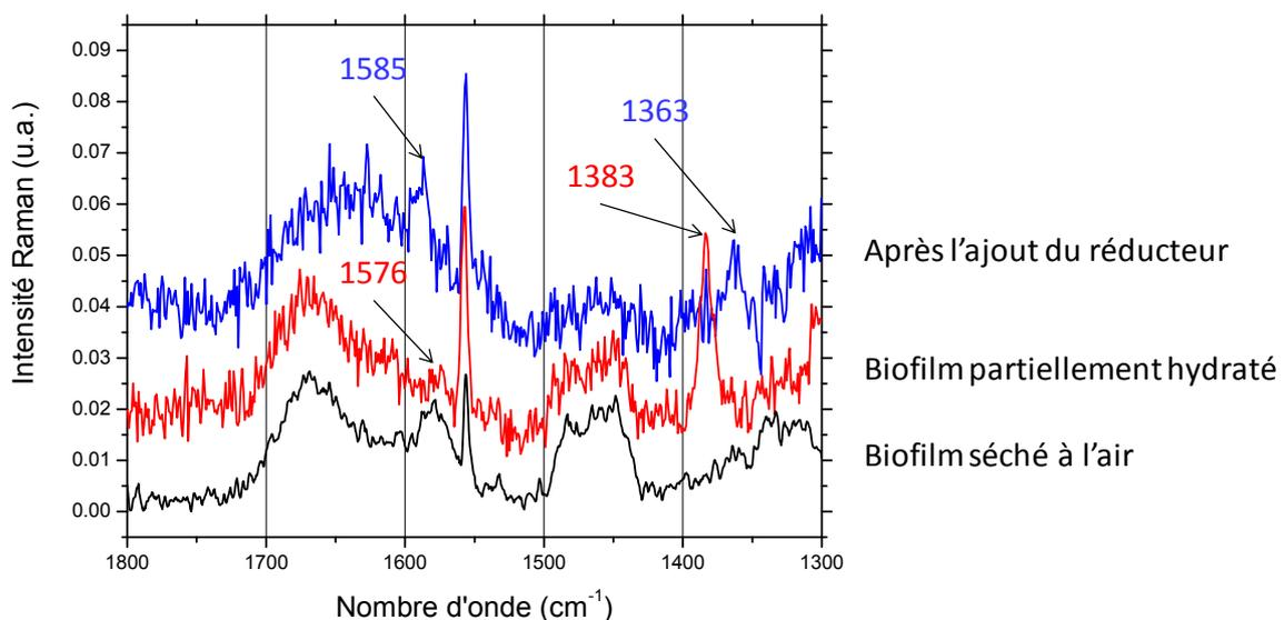
Figure IV.10 : Effet de l'ajout d'un agent réducteur sur la signature Raman d'un biofilm de 24 h de *P. fluorescens* séché à l'air,  $\lambda_{\text{ex}}$  : 514 nm, réseau à 1200 traits
