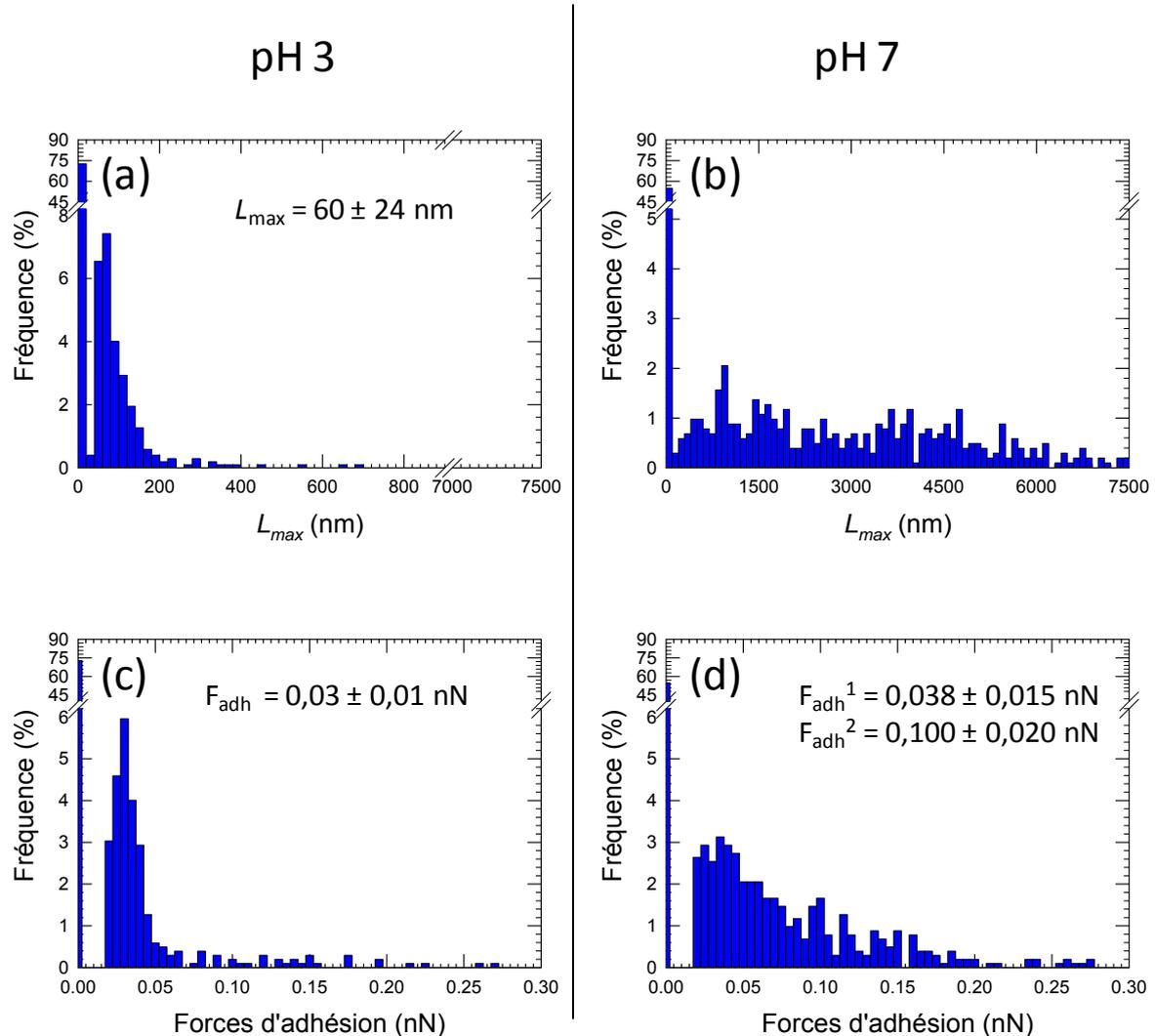
Figure V.20 : Comparaison des propriétés conformationnelles des exopolymères riches en N-acétylglucosamine d'un biofilm d'*E. coli* formé à pH 3 (a, c) et à pH 7 (b, d) ; (a, b) longueur de rupture maximale  $L_{max}$ , (c, d) force d'adhésion.
