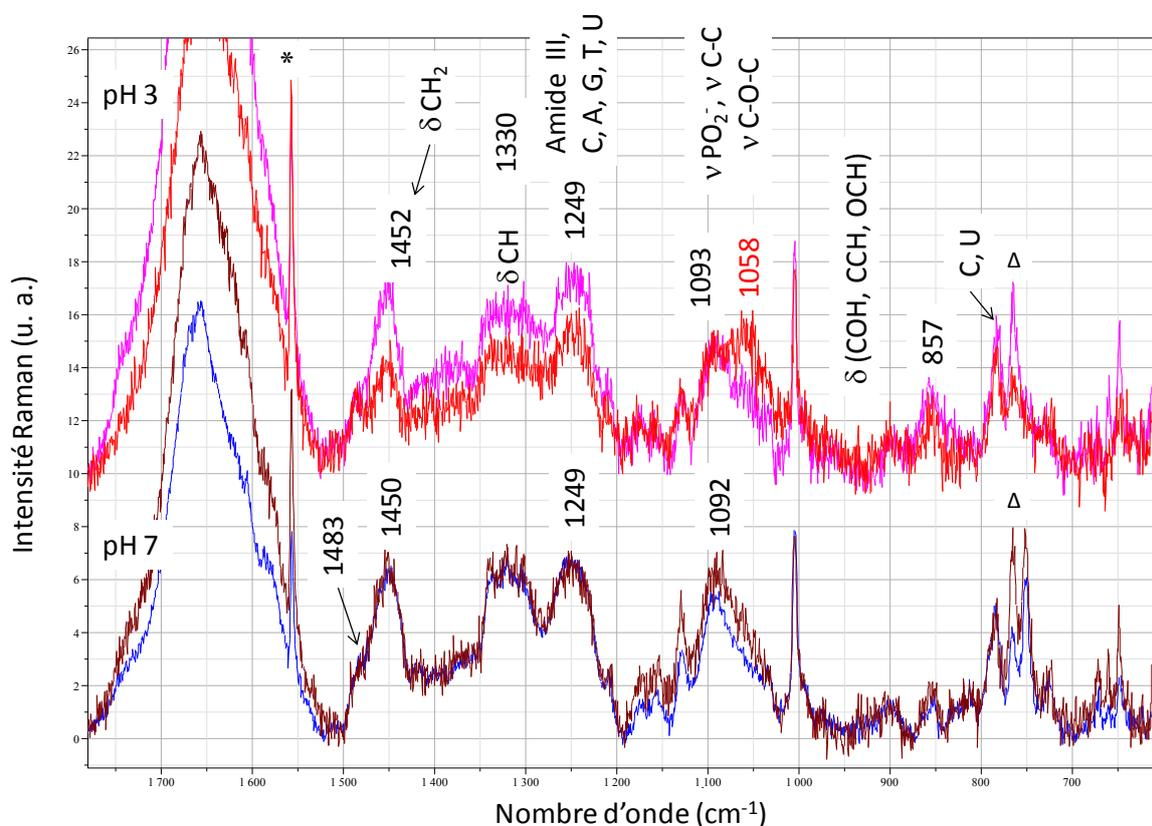
Figure V.5 : Spectres Raman d'un biofilm hydraté de *P. fluorescens* de 24 h formé dans un milieu LB/50 à pH 7 et 3. Longueur d'onde d'excitation : 530 nm. Les spectres correspondent à des régions différentes des biofilm et sont normés par rapport à la bande à 1003  $\text{cm}^{-1}$ , réseau à 1800 traits ( $\Delta$ , \* bandes attribuées au Ge et à l' $\text{O}_2$  respectivement)
