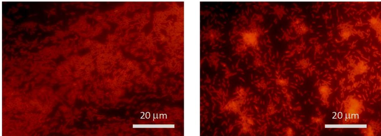
Figure V.4 : Images représentatives par microscopie à épifluorescence d'un biofilm de 24 h de *P. fluorescens*, formé sous condition de stress acide, suite au test *BacLight*<sup>TM</sup>, (mélange de Syto 9, fluorochrome vert des cellules intactes, et d'iodure de propidium, fluorochrome rouge des cellules à membranes endommagées), les images présentées sont enregistrées à deux endroits différents du cristal
