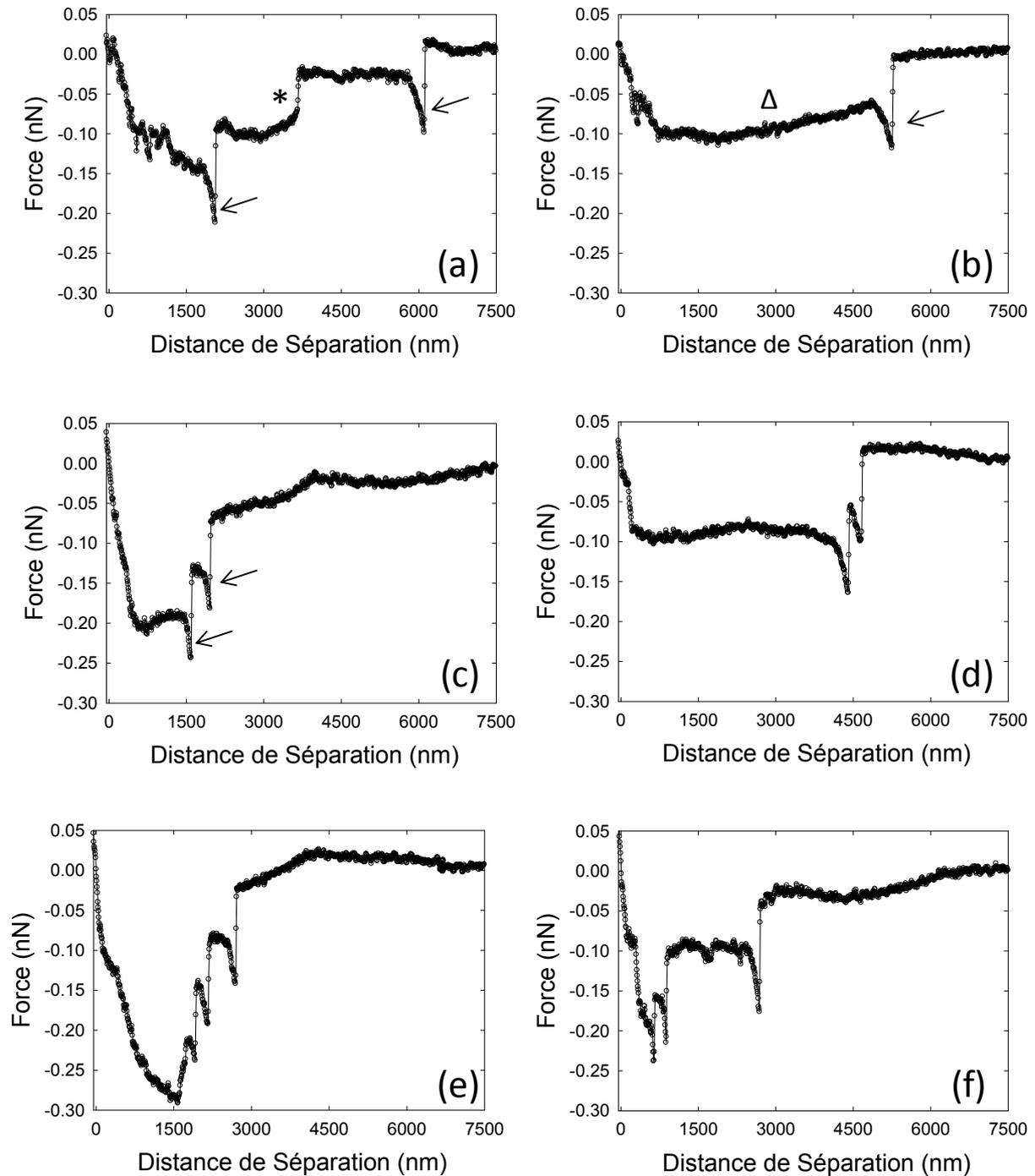
Figure IV.29 : Courbes de force-distance expérimentales représentatives (courbes de retrait) enregistrées en utilisant une sonde fonctionnalisée avec la WGA sur un biofilm d'*E. coli* de 24 h, chaque courbe de force-distance correspond à une région distincte d'un même échantillon, (\* : transition sous forme d'escalier,  $\Delta$  : plateau, les flèches indiquent des événements de rupture)
