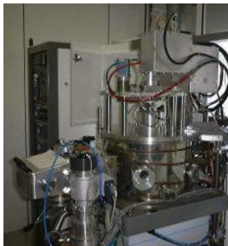
Figure 4.4 Machine de dépôt par pulvérisation cathodique (AC 450 d'Alliance Concept) [73]
