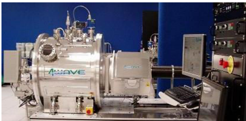
Figure 4.8 Bâti de gravure ionique IBE 4 Wave
