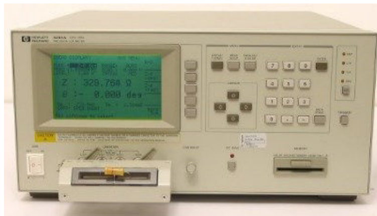
Figure 4.17 Mesure par l'impédance mètre HP 4284A
