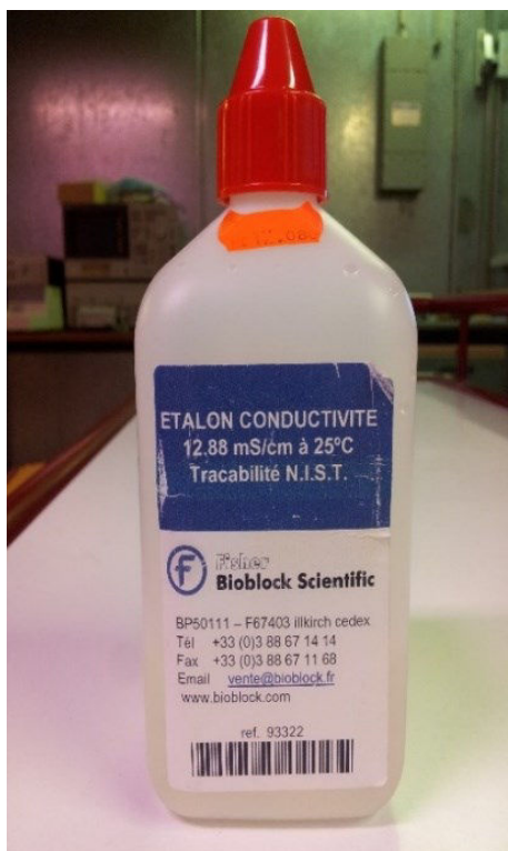
Figure 4.18 Une solution étalon ( \sigma = 12,88\mu\text{S}/\text{cm} ) utilisée
