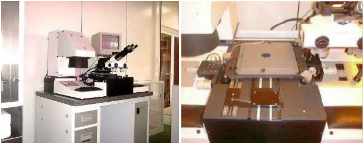
Figure 4.7 Aligneuse de masque et insolateur UV (MA 750 de Süss Microtec) [74]
