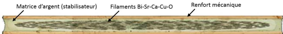
Figure 3-6 Ruban de type HT renforcé mécanique.
