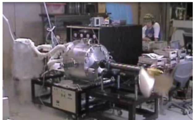
Figure 1-23 Moteur synchrone à flux axial avec un inducteur comportant des aimants supraconducteurs réalisé par l'entreprise KITANO® (16 kW – 760 tr/min) [Mik06].
