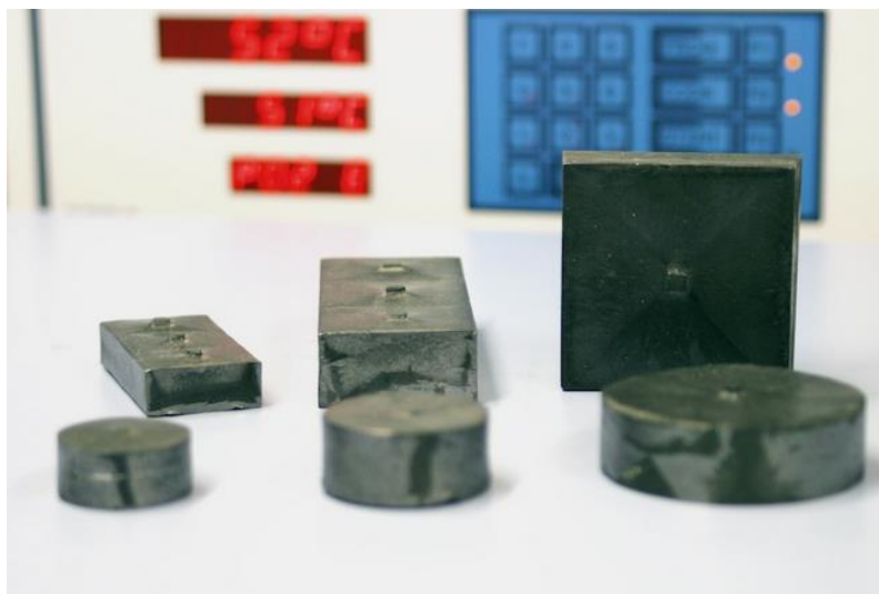
Figure 1-7 Exemple de matériaux supraconducteurs massifs de composition YBCO commercialisés par l'entreprise EVICO® [Evi].
