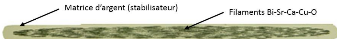
Figure 1-10 Section d'un ruban supraconducteur BSCCO de type H (SUMITOMO®).
