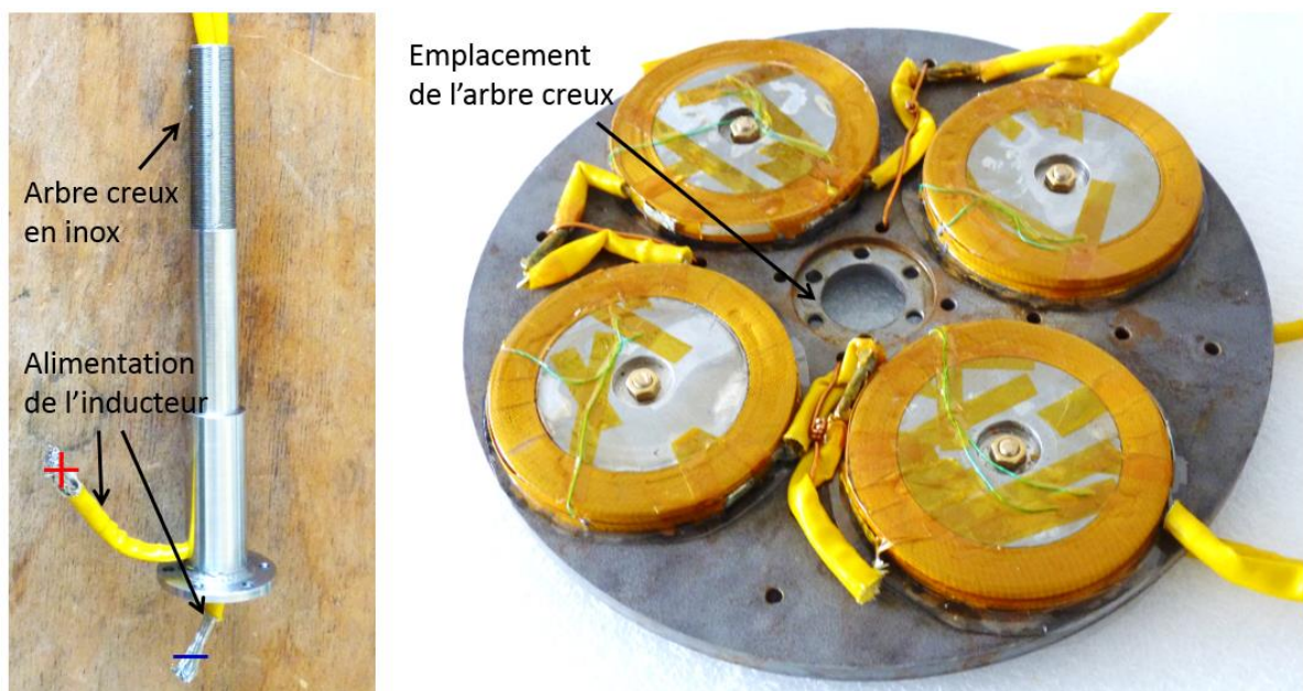
Figure 5-17 Assemblage de l'inducteur.
