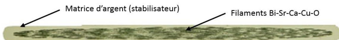
Figure 3-1 Photographie de la section d'un ruban BSCCO type H.
