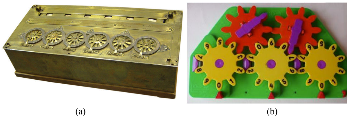
Figure 2.2 – (a) Une pascaline , signée par Pascal en 1652, visible au musée des arts et métiers à Paris (Source Wikipédia). (b) une pascaline dans sa version éducation appelée « Zéro+1 ».
