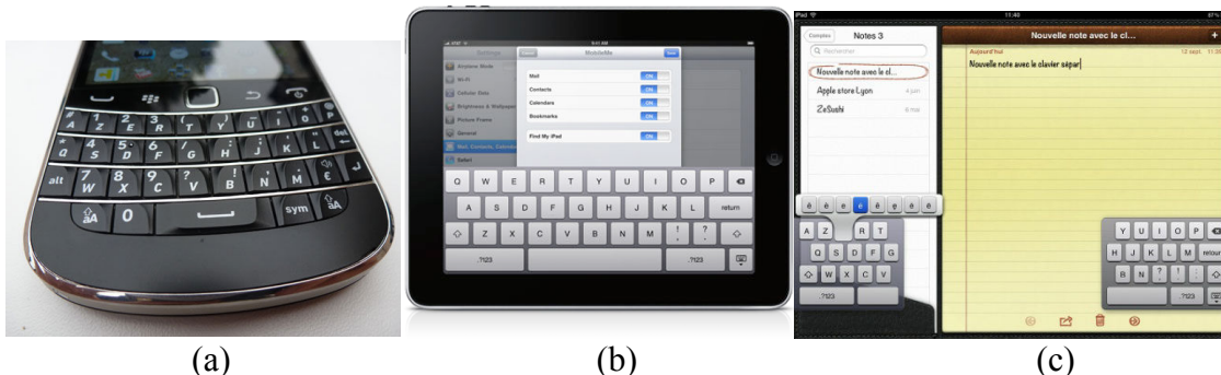
Figure 2.8 – Différents claviers de TM : (a) clavier mécanique d'un BlackBerry, (b) clavier logiciel de l'iPad, (c) clavier séparé de l'iPad.
