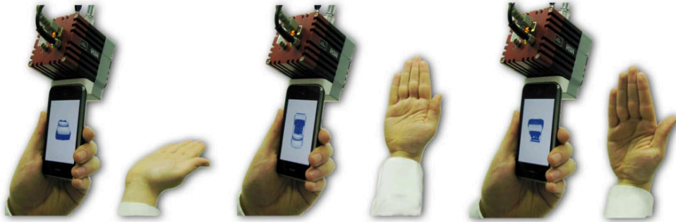
Figure 2.45 – PalmSpace (Kratz et al., 2012) : Utilisation d’une caméra de profondeur pour détecter les mouvements de la main et appliquer les rotations correspondantes à une objet de l’espace.
