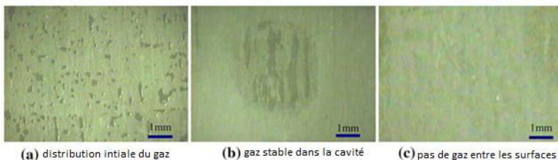
*Figure I-3 : gaz à l'interface entre la surface et le verre avant et après rodage : a) distribution initiale de gaz avant rodage (b) gaz stable dans une cavité après rodage (c) pas de gaz après rodage [39]*
