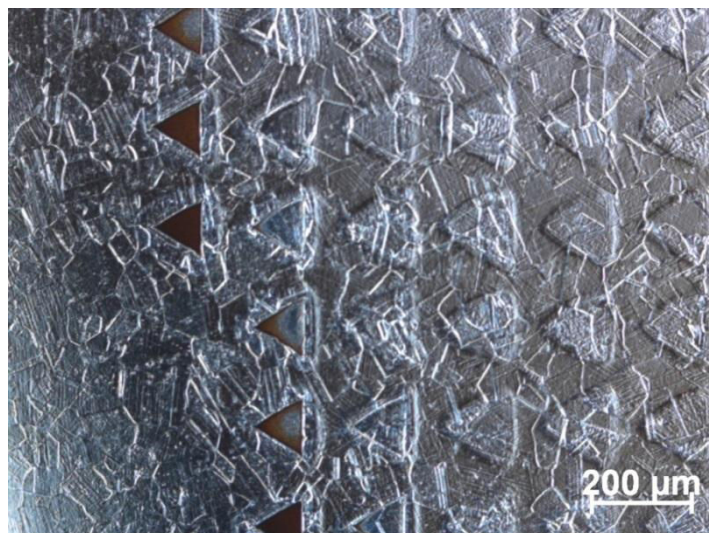
Figure V-21 : résidus de résine sur le bord de la surface structurée par nitruration
