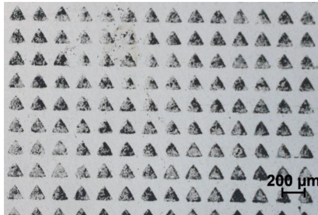
Figure V-11 : dépôt par tamponnage de poudre de BN, image de microscopie optique
