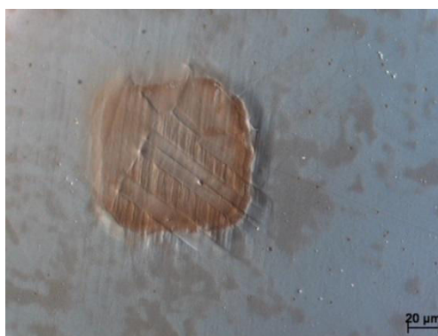
Figure IV-19 : structure carrée réalisée par carburation (3h)
