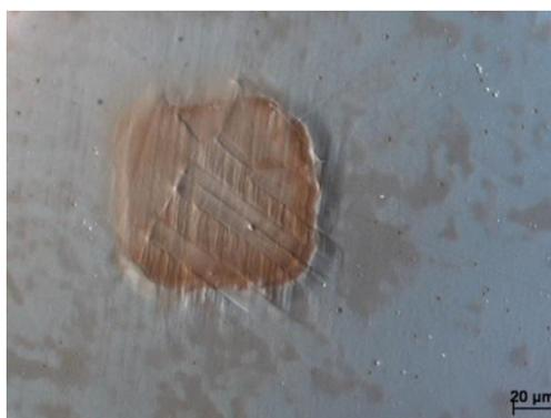
*Figure IV-19 : structure carrée réalisée par carburation (3h)*
