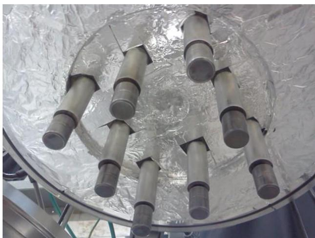
*Figure II-3 : antennes avec aimants disposées en matrice carrée*
