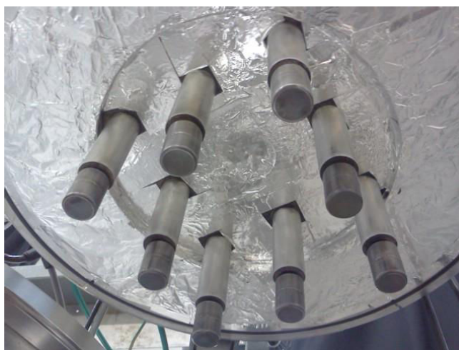
Figure II-3 : antennes avec aimants disposées en matrice carrée
