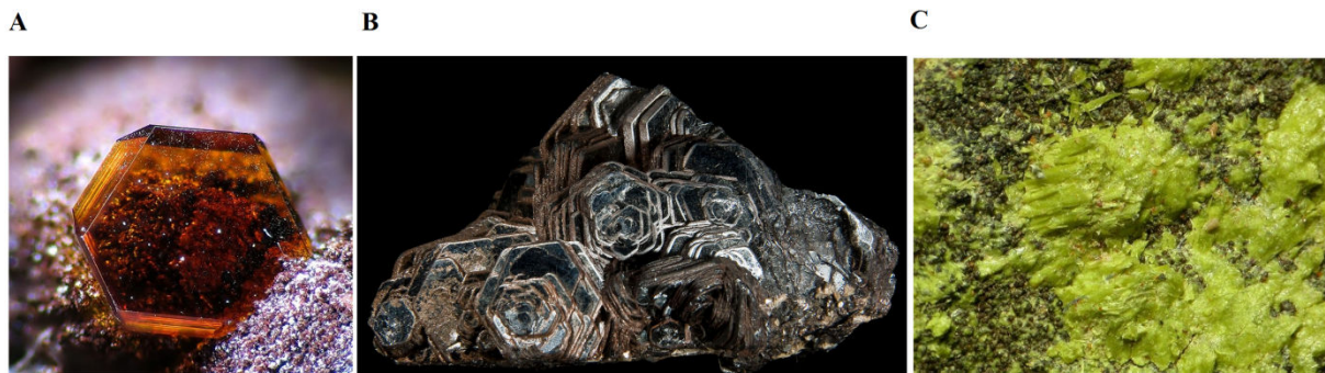
Figure 28: (A) Jarosite : sulfate de fer(III) XFe_3(SO_4)_2(OH)_6 avec X=H_3O^+, NH_4^+, K^+, Ag^+ , (B) Hématite , oxyde de fer Fe_2O_3 + nH_2O , (C) Nontronite , phyllosilicate dioctaédrique Na_{0.3}Fe^{3+}_2Si_3AlO_{10}(OH)_2 \cdot 4(H_2O) .
