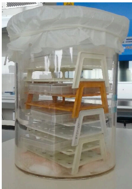
Figure 12 : Dispositif d'incubation en jarre des microplaques 96 puits
