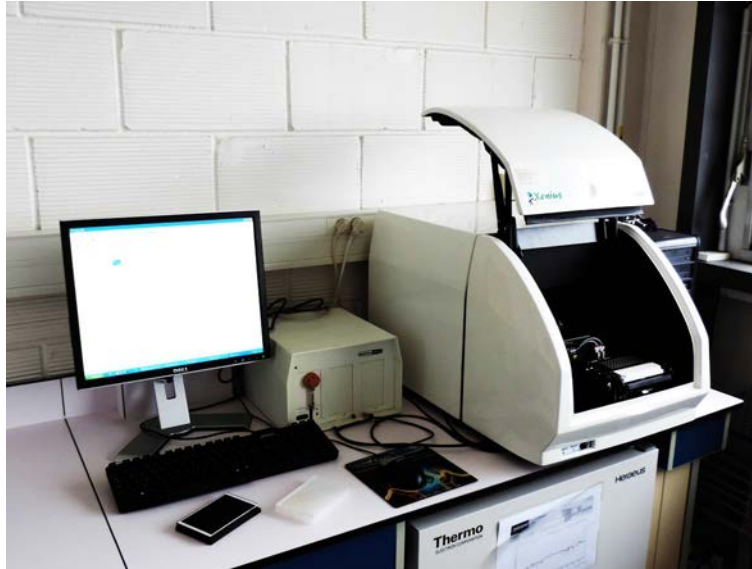
Figure 14 : Spectromètre Xenius FLX (SAFAS, Monaco) équipé d'un porte cuve (10 cuves) et d'une platine porte-échantillon, motorisés et thermo-régulés par circulation de fluide caloporteur (-5° à 80°C). Son dispositif à double-monochromateur permet des mesures d'absorbance, de fluorescence (excitation, émission et synchrone) et de luminescence (comptage de photons) sur des échantillons solides ou liquides (e.g. gel de silice GSH, suspension de biosenseurs à cellules entières)
