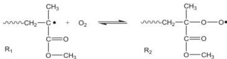
Figure A-26 : Réaction réversible de la formation du radical stable en présence d'oxygène.
