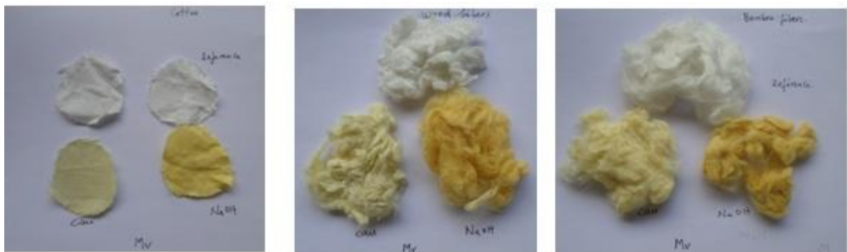
Figure 47 : Teinte obtenue après coloration avec les extraits aqueux et alcalins de movingui. De gauche à droite on a le coton, la viscose de bois et la viscose de bambou
