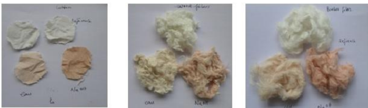
Figure 48 : Teinte obtenue après coloration avec les extraits aqueux et alcalins de padouk. De gauche à droite on a le coton, la viscose de bois et la viscose de bambou
