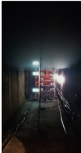
FIGURE 4.14 – Photographie de la stratification observée durant un essai avant aspersion
