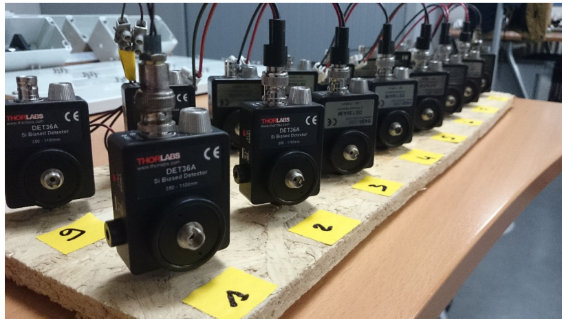
FIGURE 2.6 – Récepteurs photo-diodes utilisés pour la mesure d'opacité
