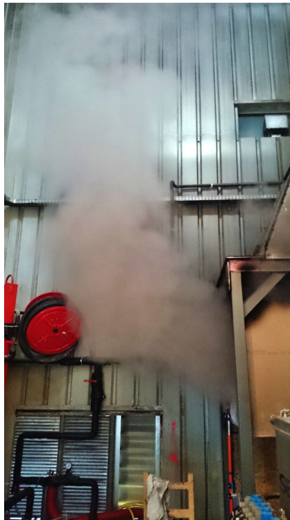
FIGURE 4.32 – Photographie du mélange fumée/eau en sortie du couloir s'élevant sous l'effet des forces de flottabilité
