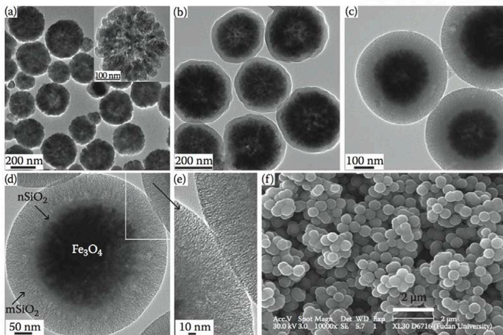
Figure 1.12. TEM images of (a)  $\text{Fe}_3\text{O}_4$  particles, (b)  $\text{Fe}_3\text{O}_4@SiO_2$ , and (c–e)  $\text{Fe}_3\text{O}_4@nSiO_2@mSiO_2$  microspheres, and (f) SEM image of  $\text{Fe}_3\text{O}_4@nSiO_2@mSiO_2$  microspheres.<sup>144,145</sup>
