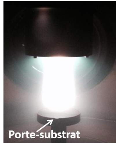
Figure II.3 Photographie du réacteur en fonctionnement (He pur) avec la cathode magnétron placée en configuration ①. Un porte-substrat est placé en face de la cathode magnétron pour les dépôts.
