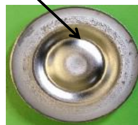
Figure II.7 Photographie d'une cible de tungstène de 5 cm de diamètre après une dizaine d'heures d'utilisation.
