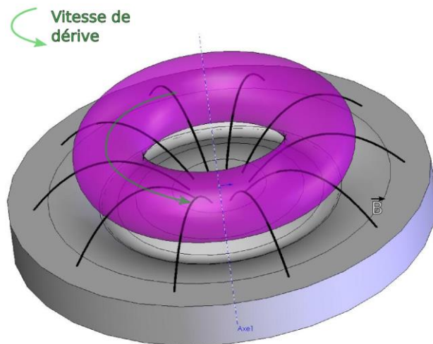
Figure I.2 Forme typique (tore) du plasma magnétron au-dessus de la cible, issu de [Imbert 2006].
