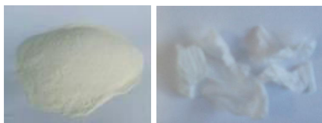
Figure V.22 : Illustration de l'apparence de la poudre d'HEC avant (à gauche) et après (à droite) purification.
