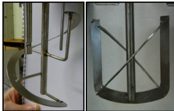
Figure IV.16 : Photographies des deux mobiles d'agitation utilisés avec le ruban hélicoïdal à gauche et l'ancre hélicoïdale à droite.
